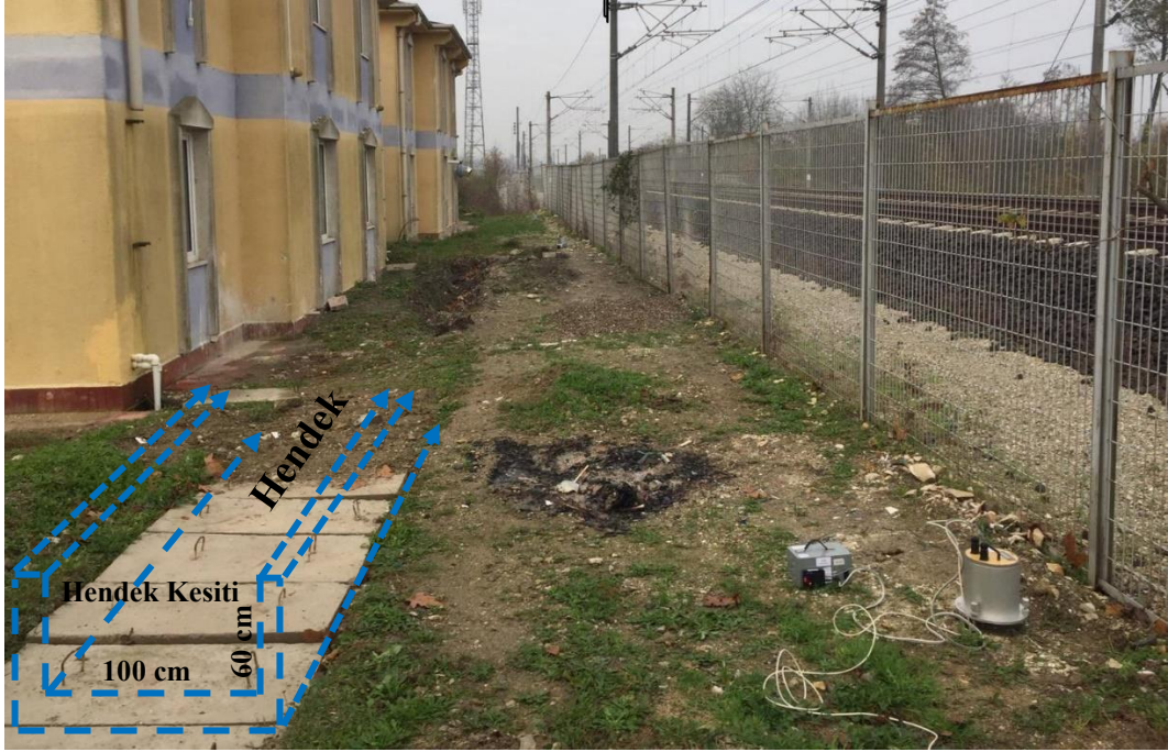
Şekil 2.7. Sapanca/Kırkpınar test alanında bulunan hendek [59]
