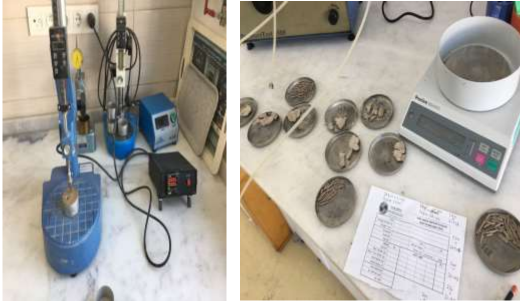
Şekil 4.8. Koni penetrasyon yöntemi ile likit limit deneylerinin yapılışı
