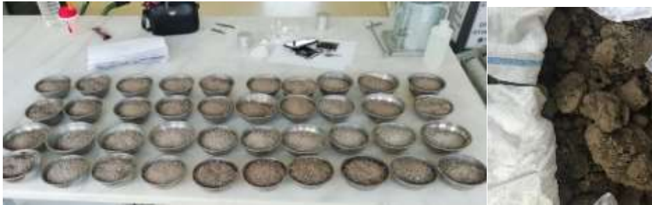
Şekil 4.1. Kil zemin ve 4 nolu elekten elenmiş numuneler
