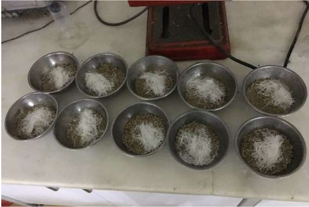
Şekil 4.13. Kil numunenin elenmesi ve zemin fiber karışımı
