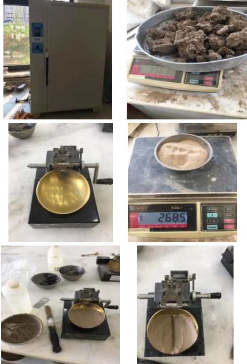
řekil 4.7. Casagrande yöntemi ile likit limit deneylerinin yapılıřı
