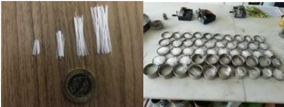
Şekil 4.3. Alkali direnci yüksek cam fiberin farklı boy ve farklı oranlarda görünümü
