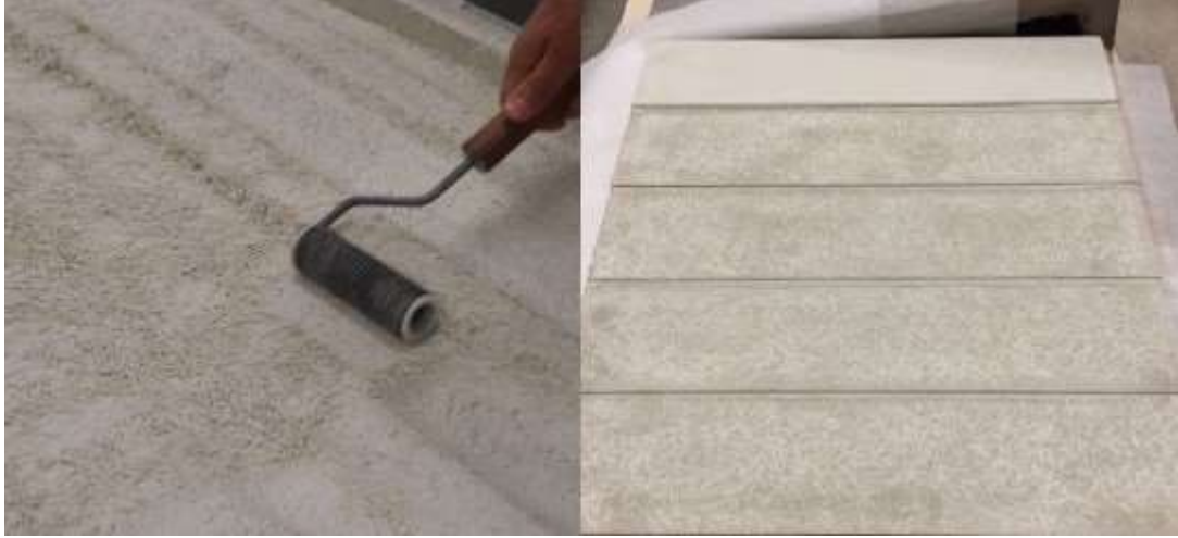
Şekil 4.4. Alkali direnci yüksek cam fiberin beton içinde lif dağılımı (Maraşlı, 2009)
