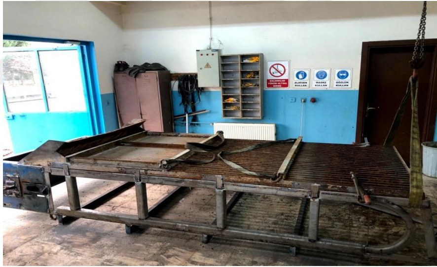
Şekil 3.9. Bir araya toplanmış ve krom kaynak uygulanmış kaba ızgara ana görseli.
