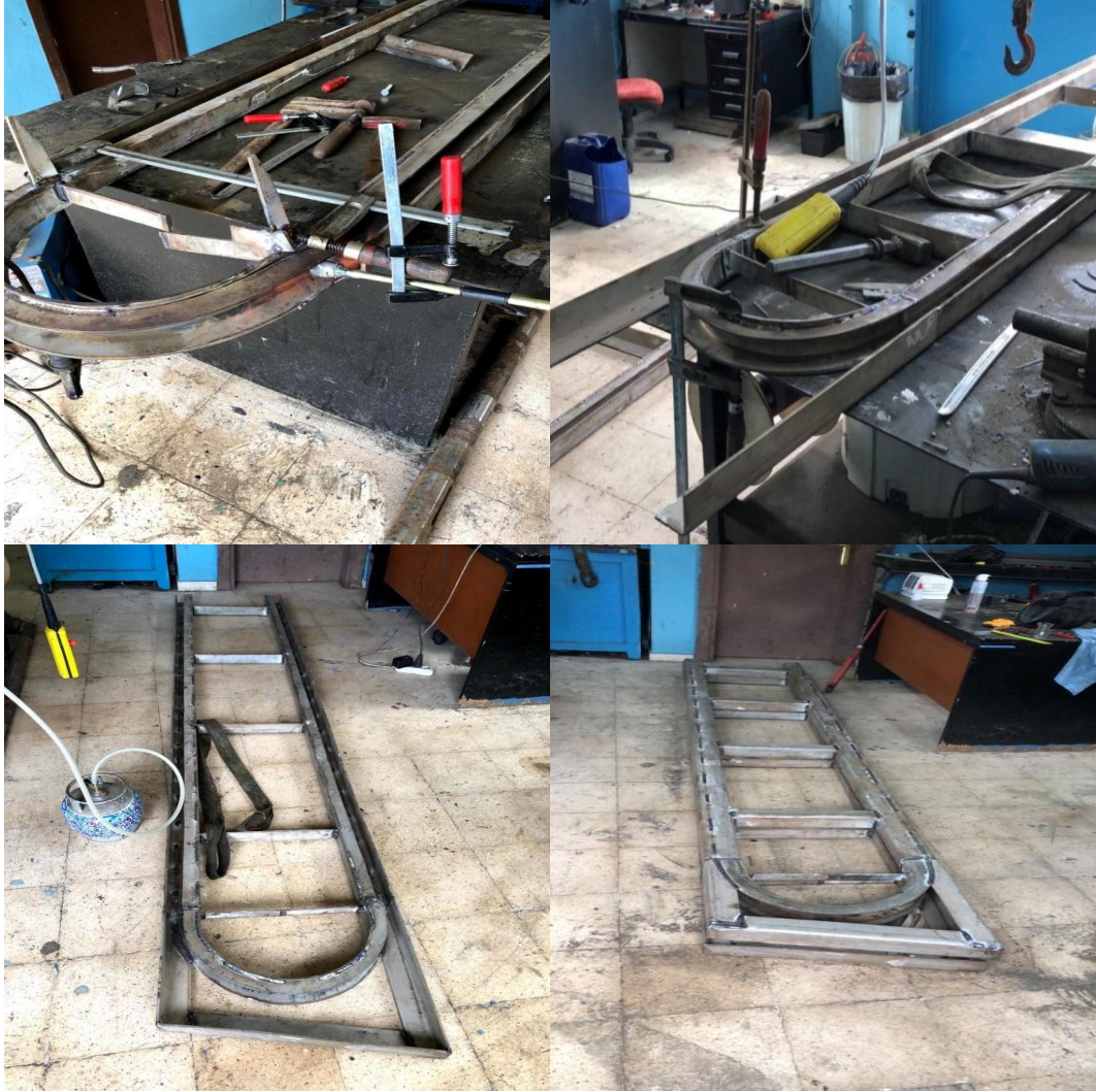
Şekil 3.16. Rayların imalat görüntüleri.
