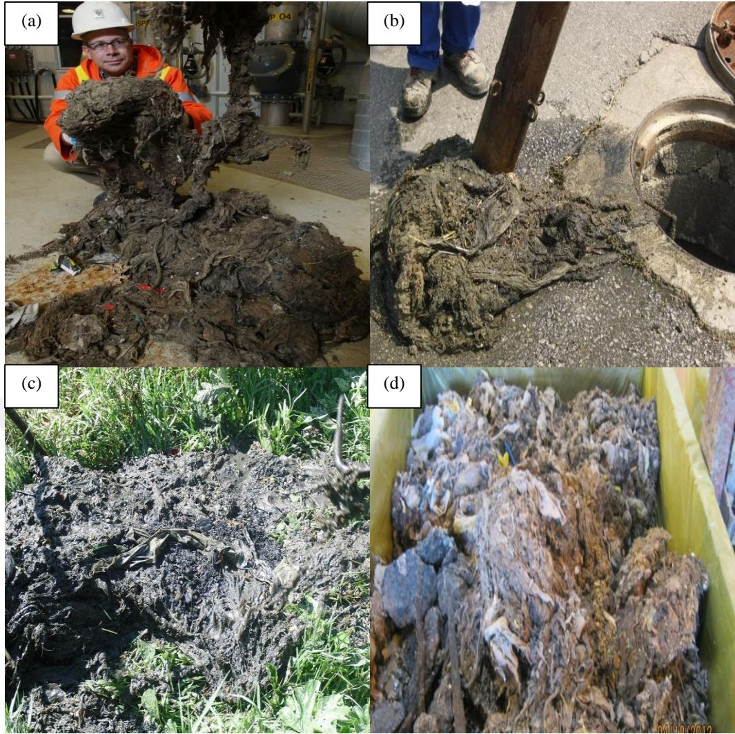
Şekil 1.1. Kanalizasyon sistemlerine atılan ve birleşerek yumaklar haline gelen atıkların, ön arıtma işlemleri ile tutulmuş olan bazı örnekleri sunulmaktadır. (a) Kanada'nın Londra şehrinde bir evsel atıksu arıtma tesisinin kaba ızgarasından çıkarılan atık kütlesi (Resimdeki kişinin (Barry Orr) izni alınmıştır. (b) Kanalizasyon sistemlerine atılmış ve birbirlerine bağlanarak yumak haline gelmiş atıklar. (c) Kırsal ve yeni yapılaşmanın olduğu bir bölgede meydana gelen bir tıkanma olayında ortaya çıkan birleşmiş atık yumağı. (d) Kanada da bulunan bir evsel atıksu arıtma tesisinin kaba ızgarasından temizlenen mendil vb. maddeler.
