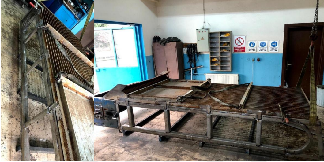
Şekil 3.17. Lamalar ve rayların birleştirilmesi.
