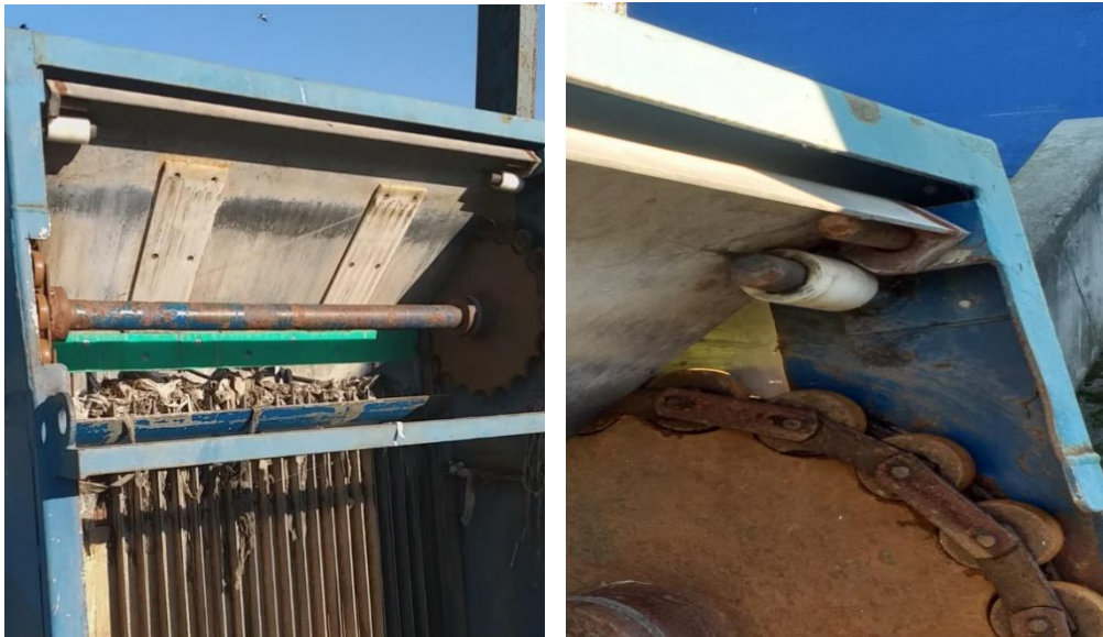
Şekil 3.14. Sıyırıcı ön görüş görseli ve bağlantı bölgesi.
