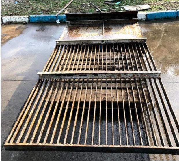
Şekil 3.15. H demiri yardımı ile bir araya getirilmiş ara boşlukları 50 mm olan ızgara lamaları.
