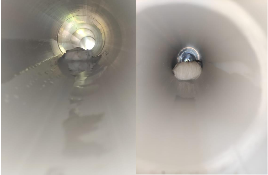
Şekil 4.26. Boru hattı içerisinde maksimum emniyetli taşıma mesafesine ulaşamayan tuvalet kağıtları
