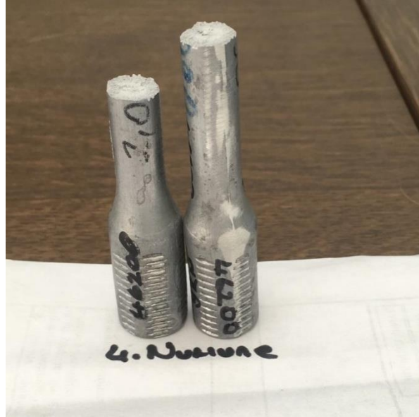
Şekil 5.23. Teste kopan numune örneği
