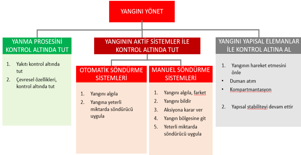
Şekil 2.3. Yangından korunum konsepti ağacı (Guide to the fire Safety concept tree NFPA550 [6] )
