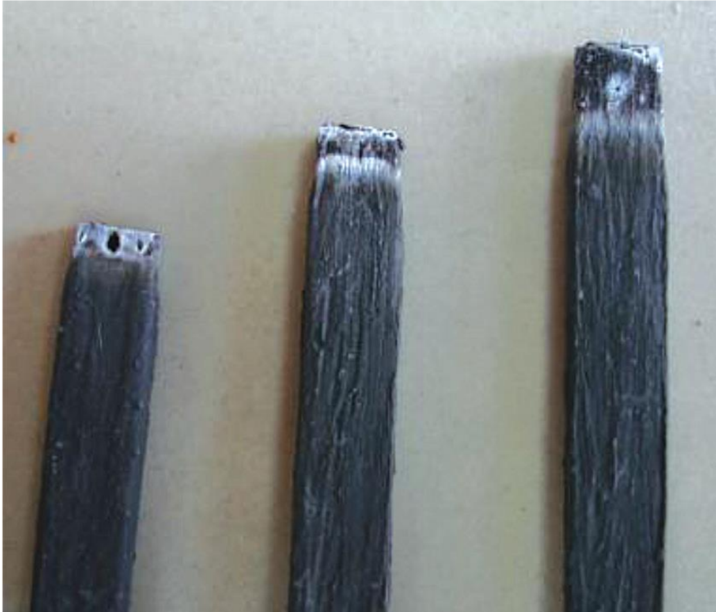
řekil 4.10. %45, %50, %55 oksijen konsantrasyonu ile yakılan numuneler
