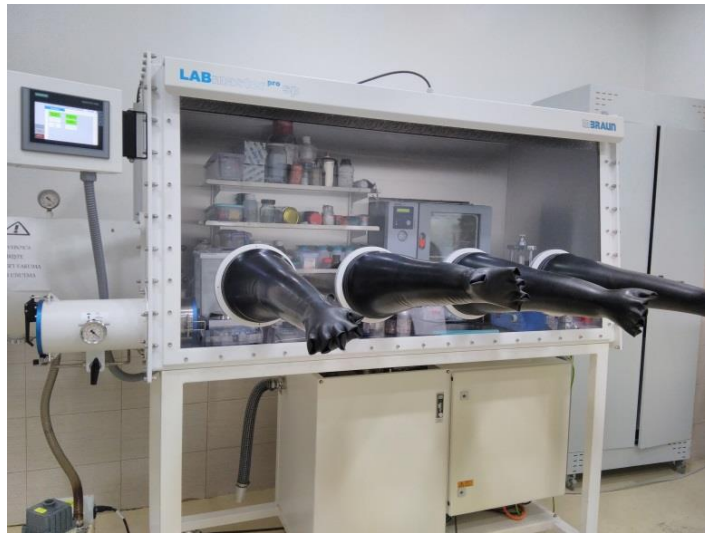
Şekil 4.2. Düğme pil üretiminde kullanılan glovebox.
