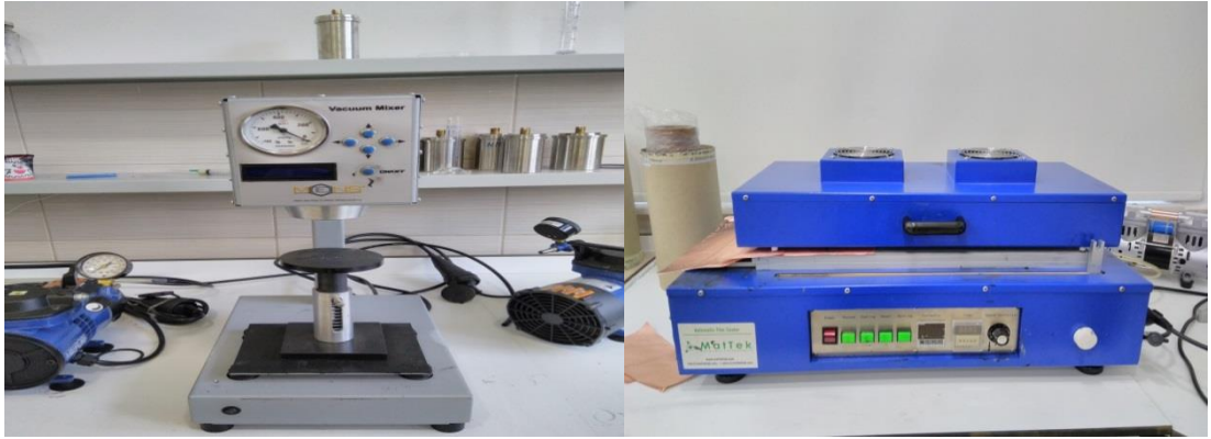
Şekil 4.1. Anot üretiminde kullanılan sol: vakumlu mikser ve sağ: Dr. Blade cihazı.
