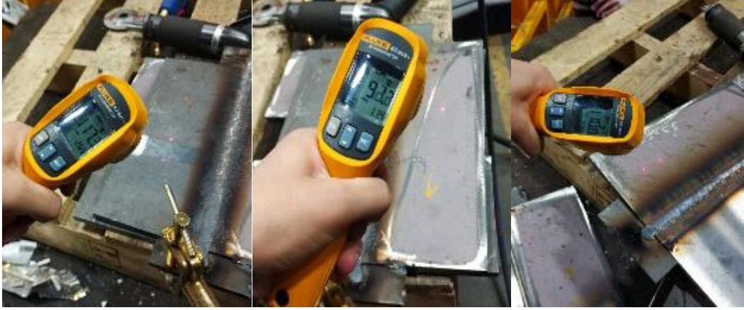
Şekil 7.4. Kaynak işleminden hemen sonra yapılan sıcaklık ölçümleri.
