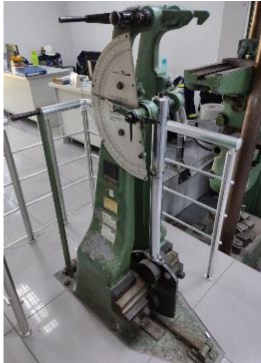
Şekil 7.17. Çentik darbe testi cihazı.
