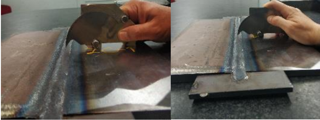
Şekil 7.6. Test parçası kaynak kep ölçümü.
