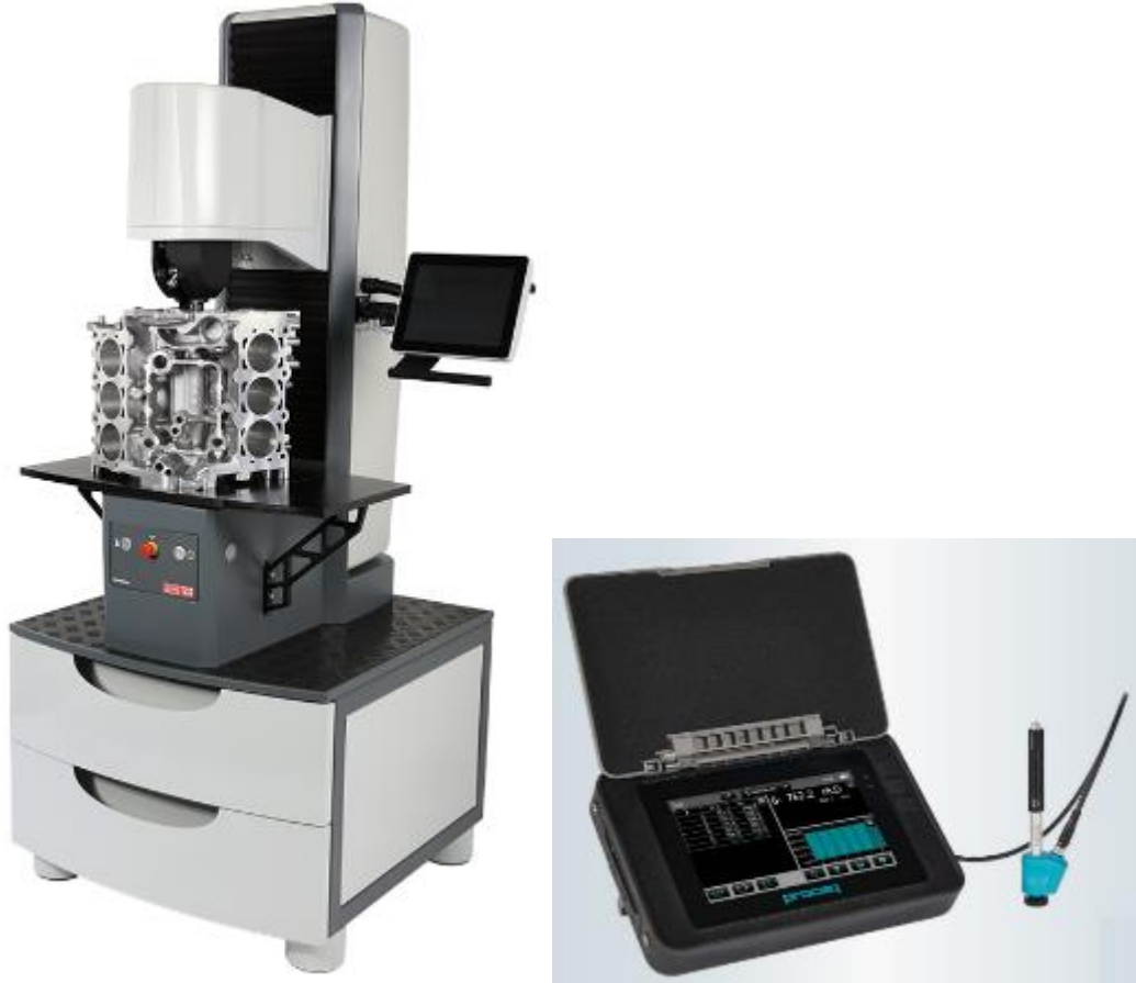
Şekil 6.20. Sabit ve portatif sertlik ölçüm cihazları [61, 62].
