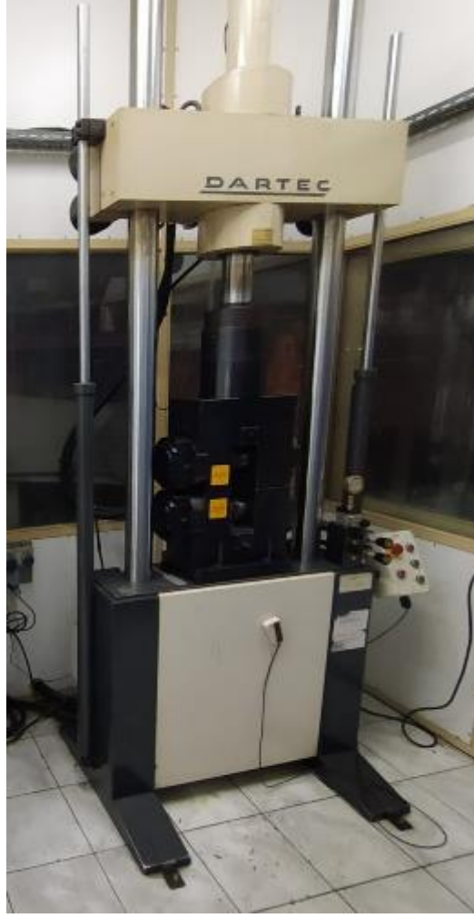
Şekil 7.13. Çekme testi cihazı.
