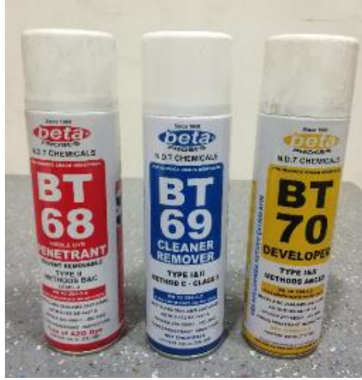
Şekil 7.7. Uygulama için kullanılan penetrant sıvısı, temizleyici ve geliştirici.
