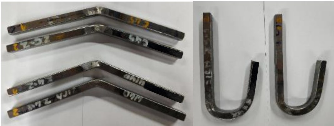
Şekil 8.21. Numunelerin açılı kırılma ve bükülme görselleri.
