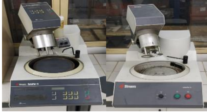
Şekil 7.23. Metalografi yüzey hazırlama cihazları.
