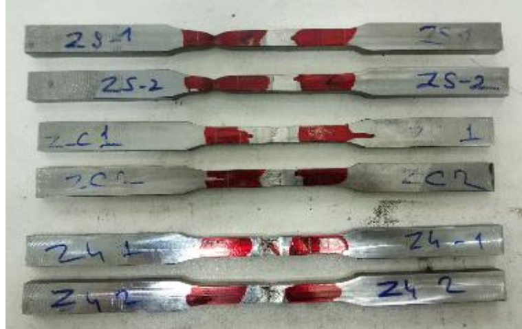
Şekil 8.4. Çekme testi sonrası numunelerin görünümü.
