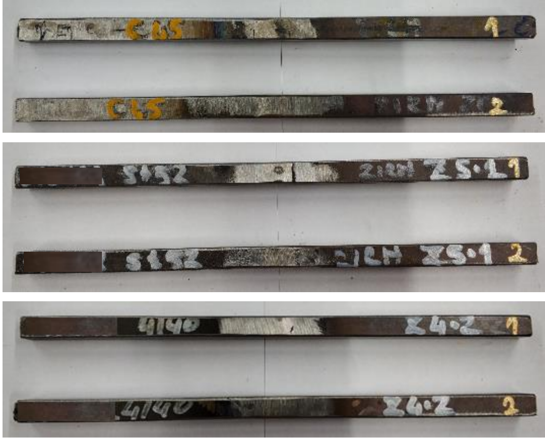
Şekil 7.18. Plakalardan çıkarılan eğme testi numuneleri.
