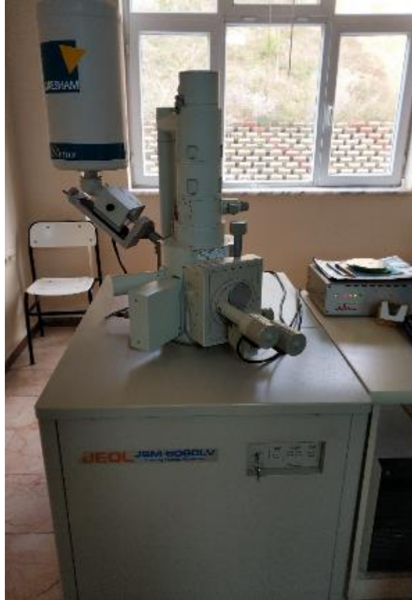
Şekil 7.25. Jeol JSM- 6060LV Model SEM cihazı (Taramalı elektron mikroskopu).
