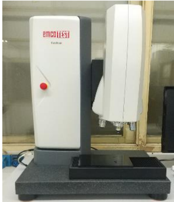
Şekil 7.20. Mikrosertlik test cihazı.
