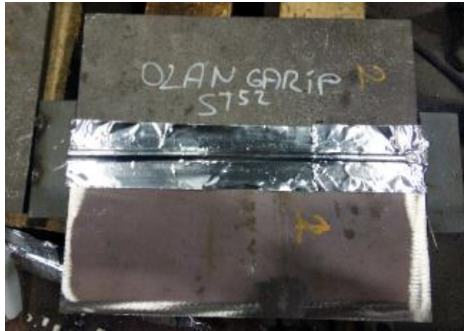
Şekil 7.1. Seramik altlık ile kaynak hazırlığı yapılmış test numunesi ve kaynatılan başlıklar.
