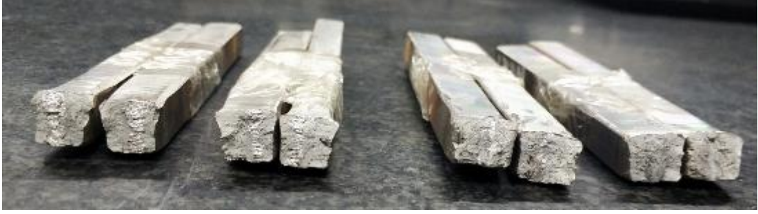
Şekil 8.22. Eğme testi numunelerinin kırık yüzey görselleri.
