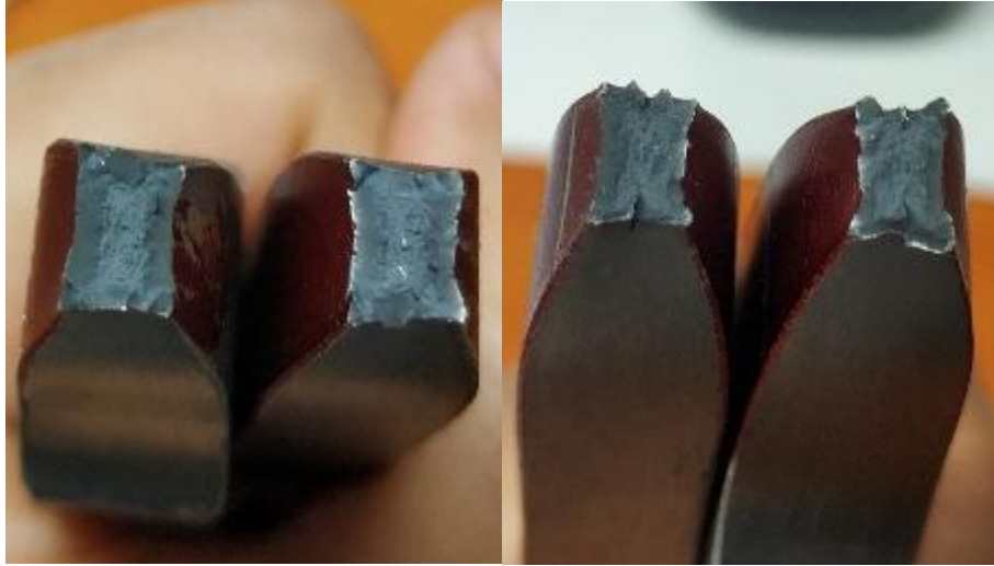
Şekil 8.7. Çekme testi sonrası T3-1 ve T3-2 nolu numunelerin kopmuş yüzey görüntüleri.
