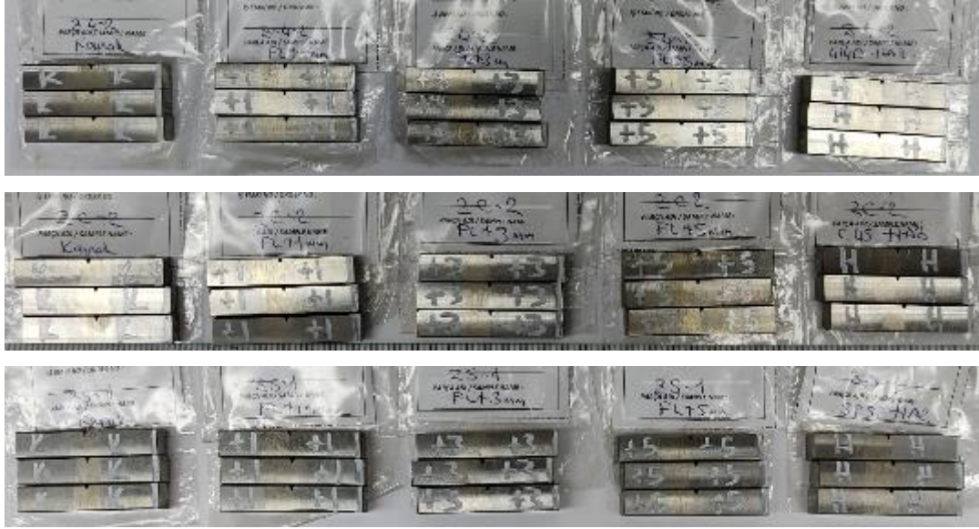
Şekil 7.16. Çentik darbe testi numuneleri.
