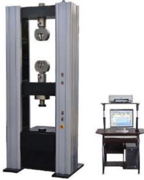
Şekil 6.16. Çekme testi cihazı [4].
