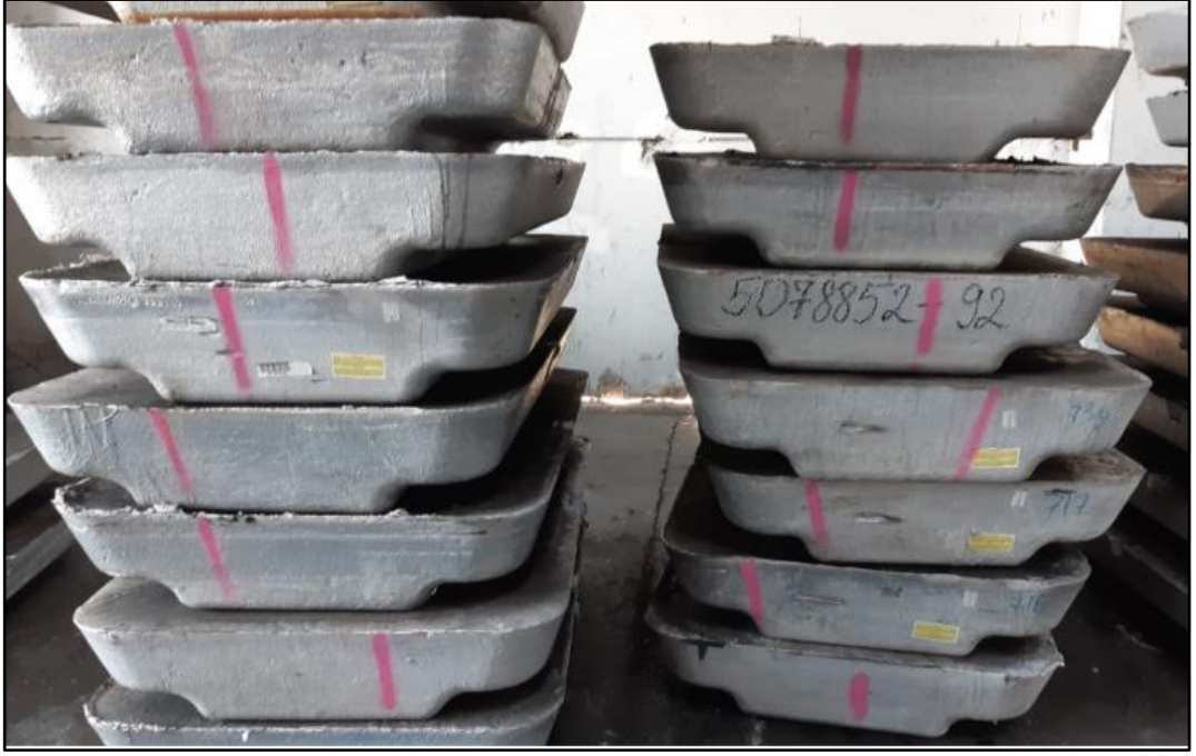
Şekil 3.6. %99.8 saflıktaki alüminyum külçe
