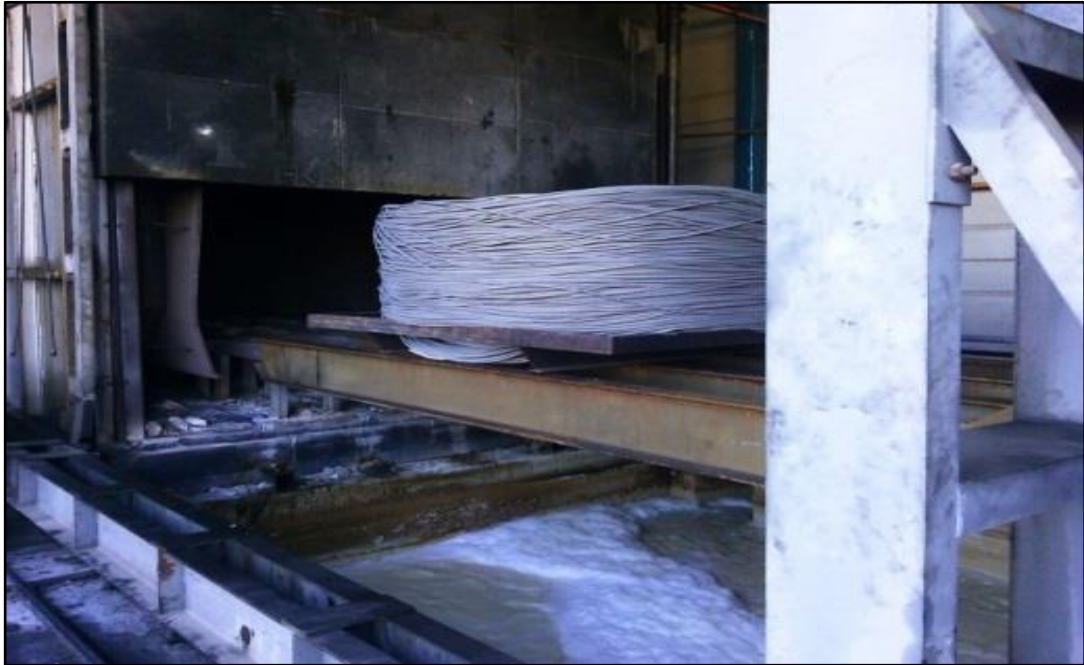
Şekil 3.20. Alüminyum filmaşine uygulanan ısıl işlem
