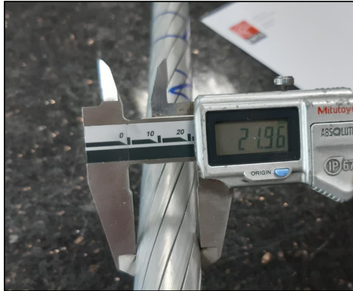
Şekil 3.30. Dış çap 21,96 mm olarak kumpas yardımıyla ölçülmüştür.
