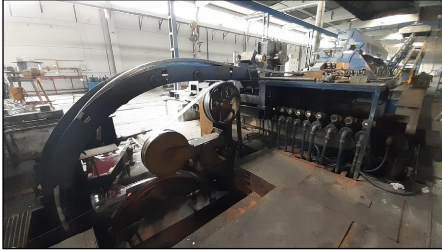
Şekil 3.10. Döküm prosesi bakır teker soğutma ünitesi ve alüminyum bara oluşumu
