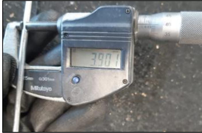
Şekil 3.39. Yuvarlak şekilli tellerin çapının ölçülmesi [4]
