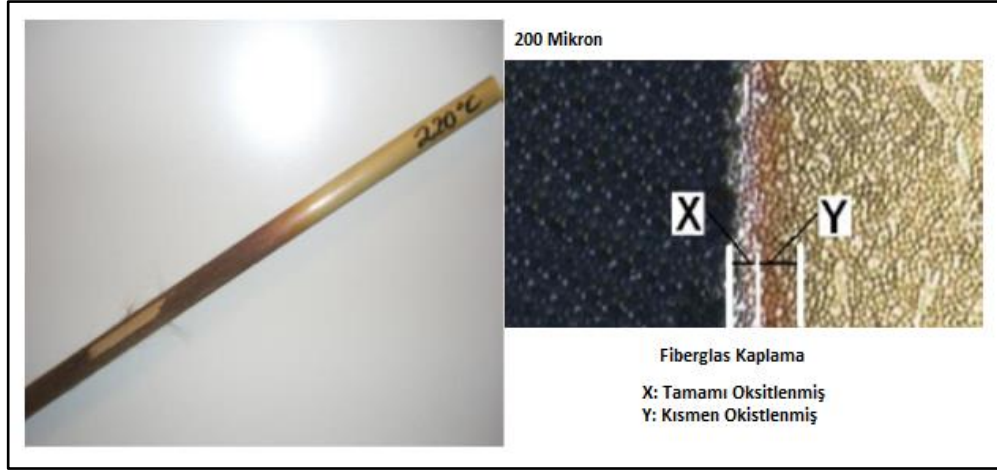
Şekil 2.22. Kompozit öz numunesinin bir yıl boyunca 220°C’de fırınladığı, Oksidasyon ~60 mikron derinliği geçmediği görülmüştür [7].
