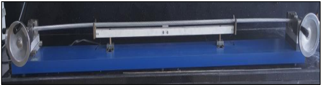
Şekil 3.43. ACCC Lisbon iletkenin direnç ölçer cihazına yerleştirilmesi
