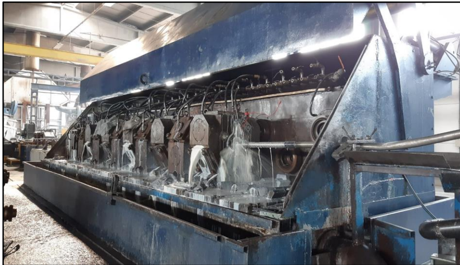
Şekil 3.11. Döküm prosesi haddeleme ünitesi
