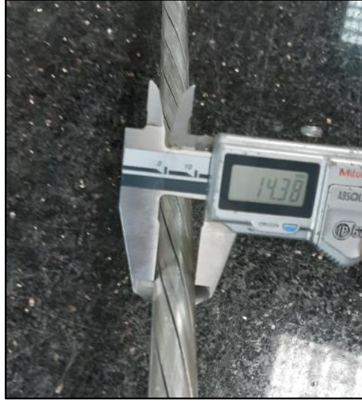
Şekil 3.35. Alt katman 6 telli tabakanın dış çapının ölçülmesi sonucu çap 14,38 mm olarak ölçülmüştür
