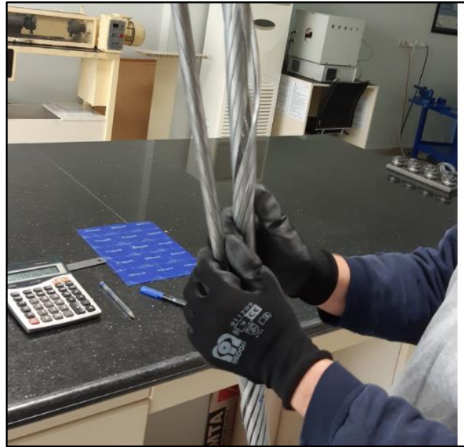
Şekil 3.32. 10 telli üst katmanın soyulması
