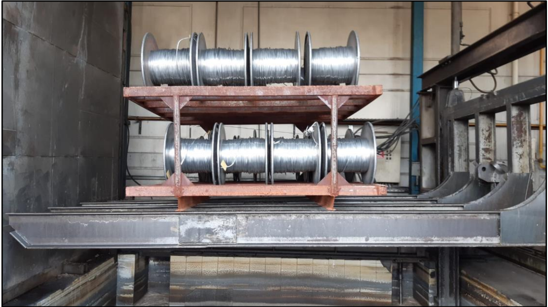
Şekil 3.21. Alüminyum tellere uygulanan ısıl işlem
