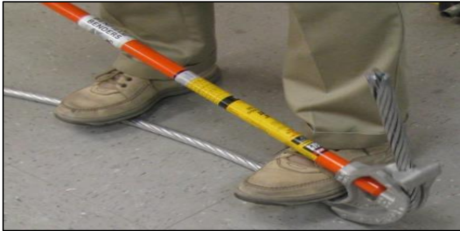
Şekil 2.19. İletken 90 derece açıyla 10 kez bükülmüştür [7].
