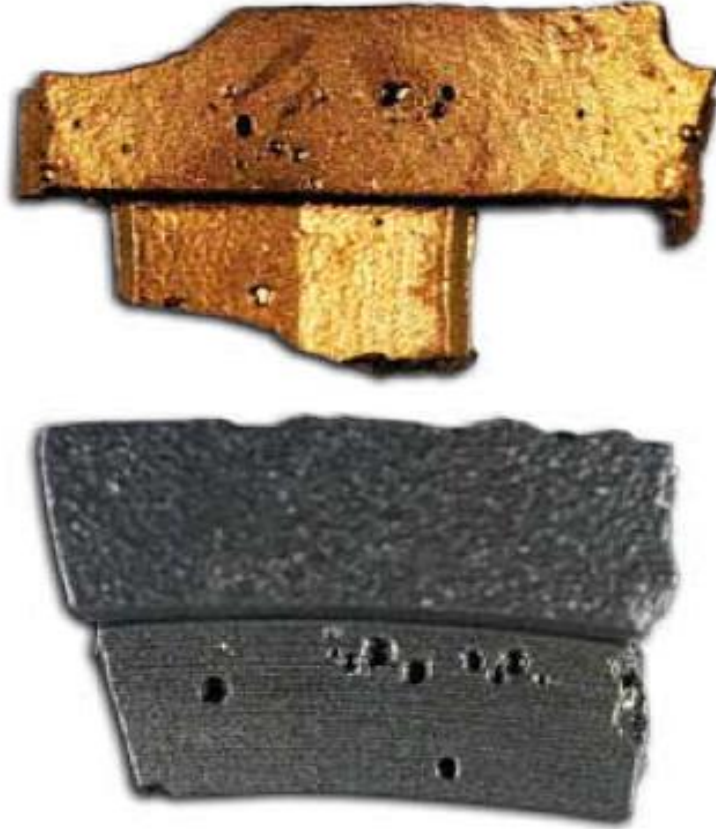
Şekil 2.4. Curuf hatası, (döküm hataları atlası, 2014)
