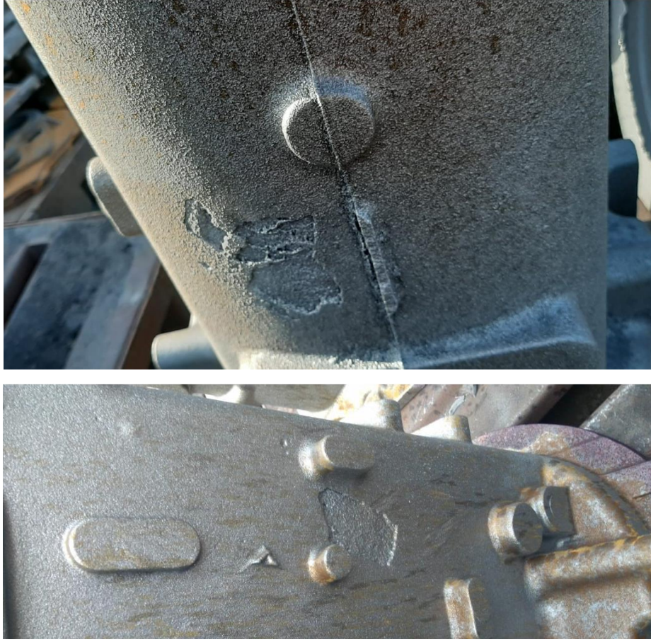
Şekil 3.7. Dişli kutusu parçasında görülen dart hatalarının örnekleri
