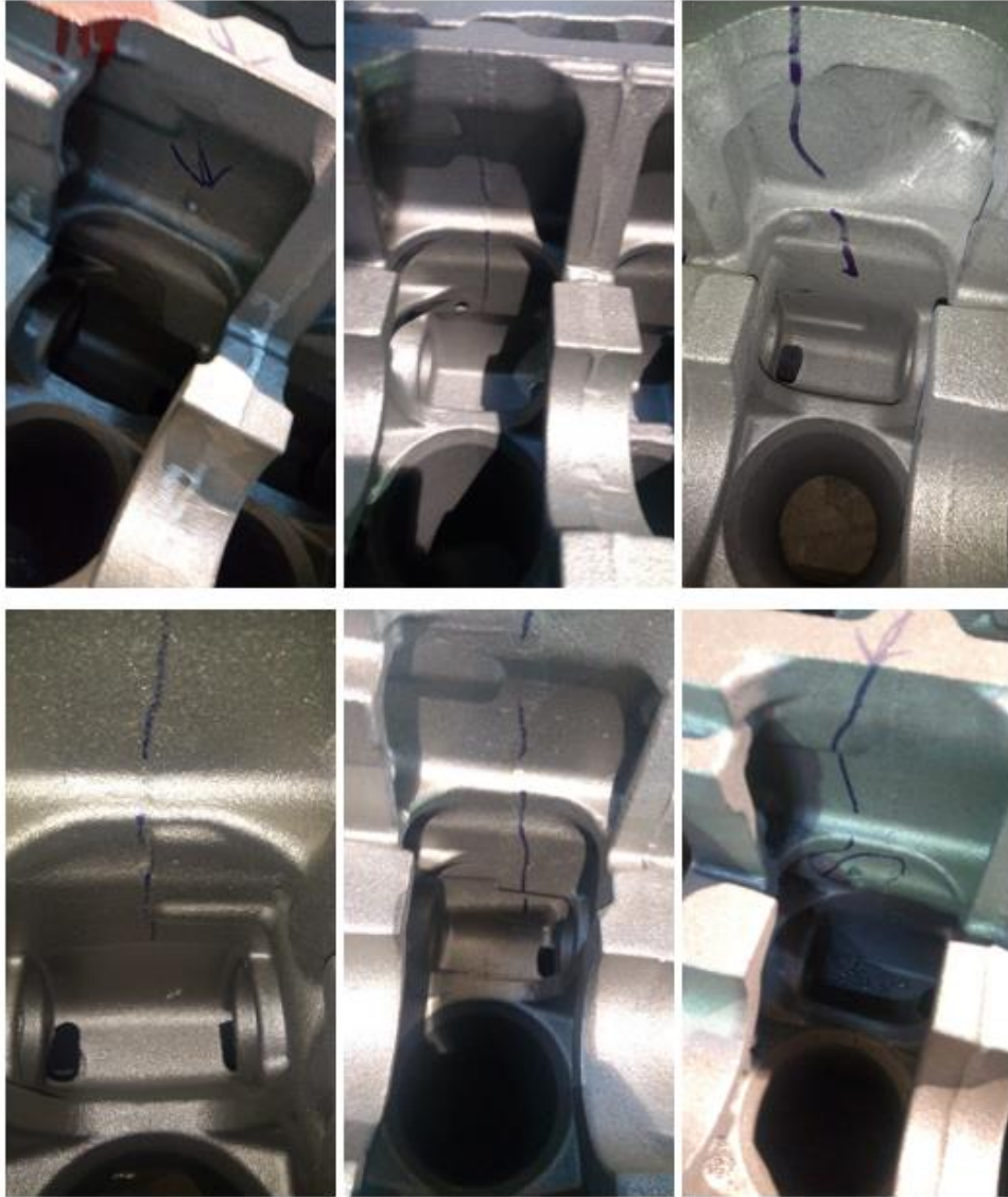
Şekil 3.1. Parçada tekrarlı olarak cüruf hatasının görüldüğü bölgeler
