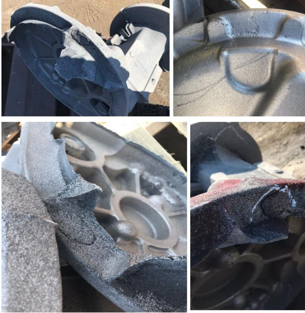
Şekil 3.16. Redüktör kovani parçasındaki dart hatası
