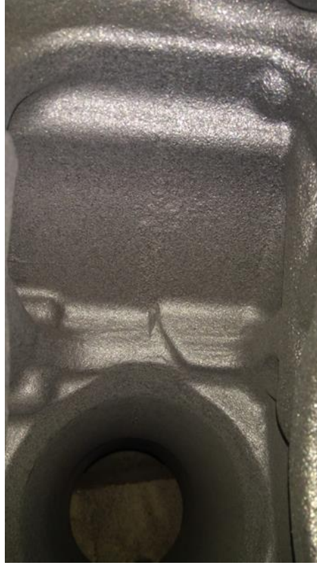
Şekil 3.6. Optimize yollukla dökülen parçalarda hatanın görülmemesi
