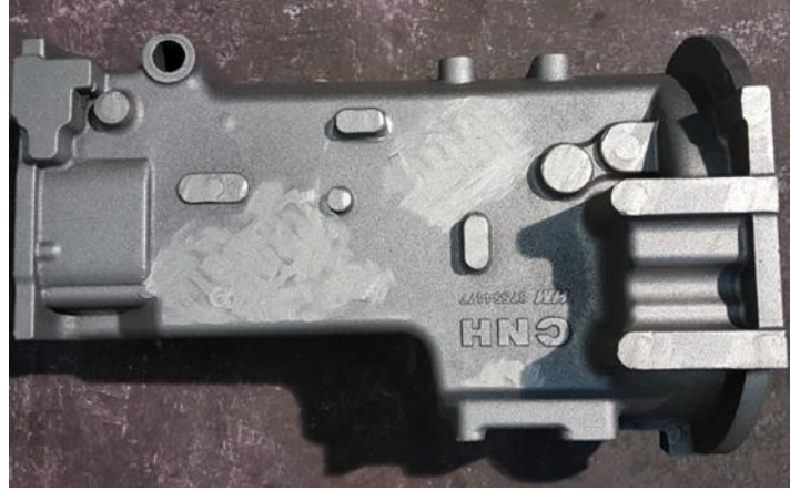
Şekil 3.15. Optimize yollukla dökülen parçalarda hatanın görülmemesi
