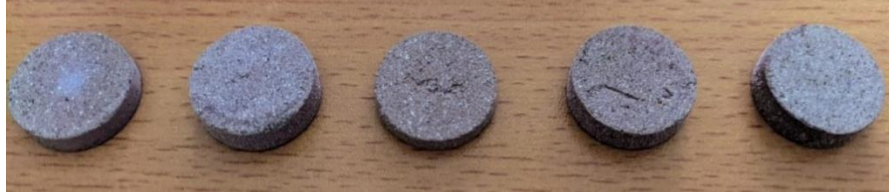
Şekil 6.17. Pamuklaşma testi sonrası zayıf pamuklaşmanın tespit edildiği numunelerin görüntüsü.
