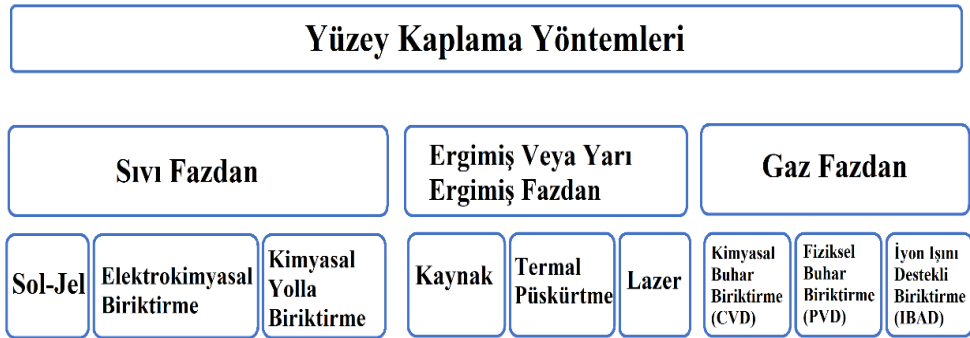
Şekil 2.1. Fonksiyonel yüzeyleri korumak için kullanılan kaplama işlemleri [22].
