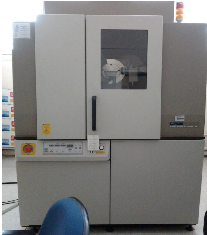
Şekil 5.17. Rigaku D/MAX 2000 X-ışınları difraktometresi
