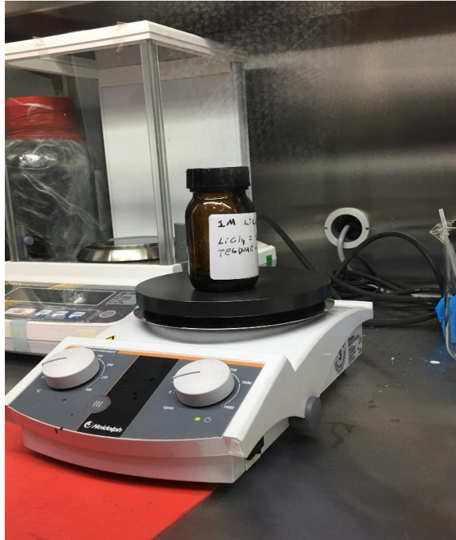
Şekil 5.11. Glovebox içerisinde sıvı elektrolit manyetik karıştırıcıda karıştırılırken
