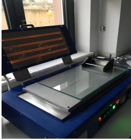
Şekil 5.12. Bir film kaplama cihazı olan doctorblade
