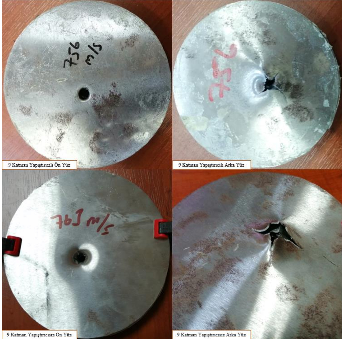
Şekil 4.3. 9 katmanlı 4340 yapıların atış sonrası deformasyonları
