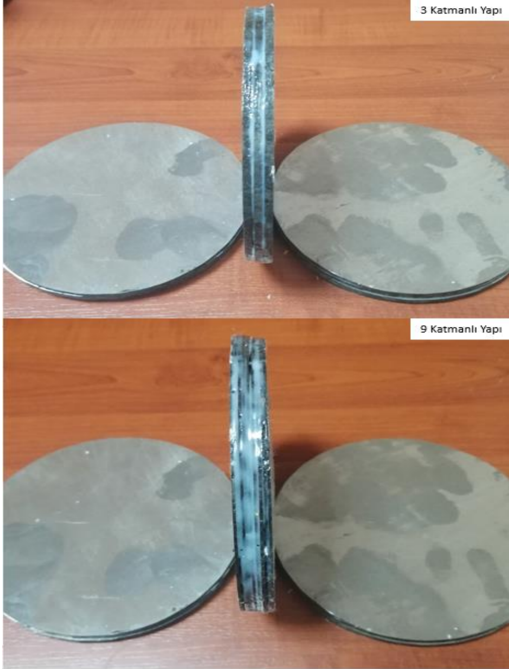
Şekil 3.6. Epoksi yapıştırıcı ile birleştirilmiş 3 ve 9 katmanlı yapılar
