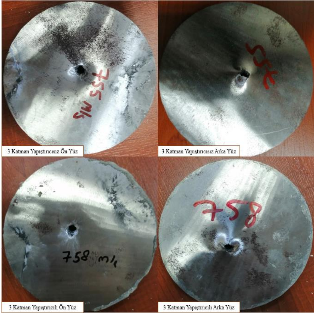
Şekil 4.2. 3 katmanlı 4340 yapıların atış sonrası deformasyonları
