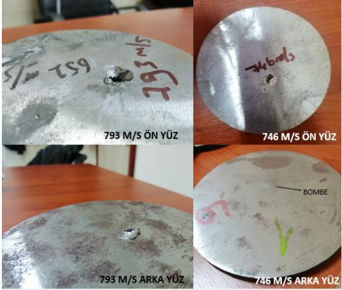
Şekil 4.1. Yekpare 4340 yapıların atış sonrası deformasyonları
