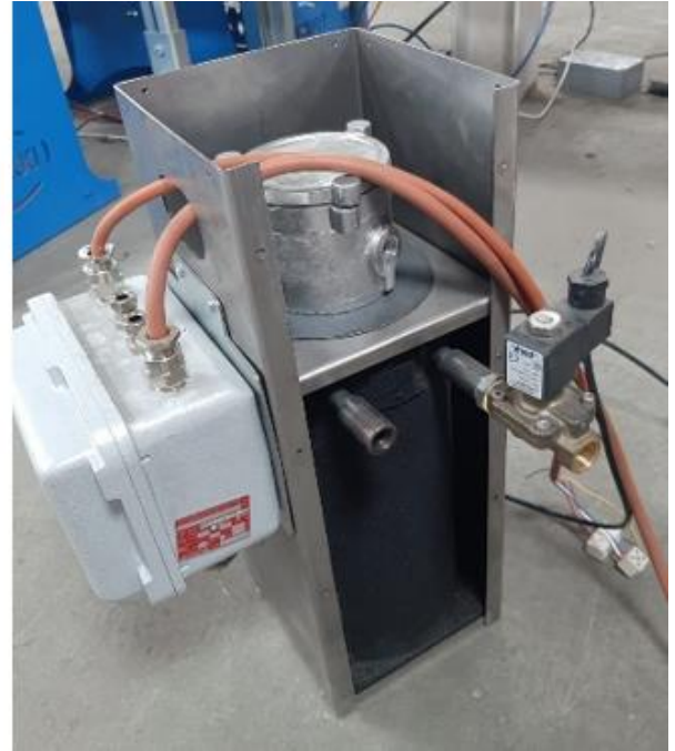
Şekil 4.5 LPG buharlaştırıcının prototip görüntüleri
