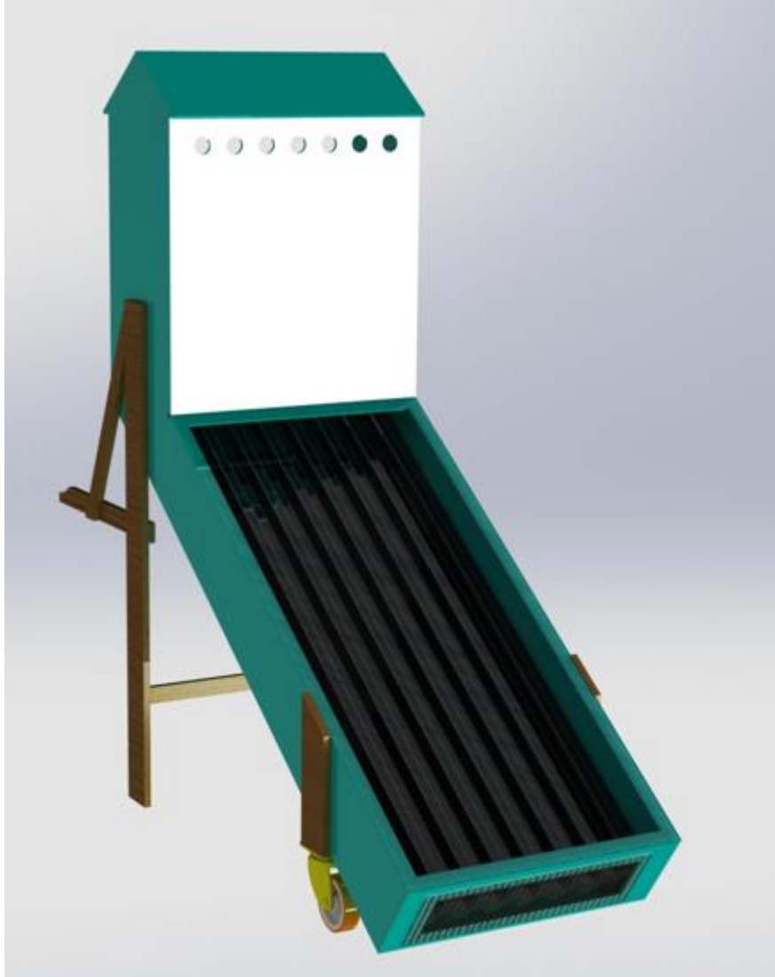
Şekil 3.4. Güneş enerjili kurutma sisteminin genel görünüşü.
