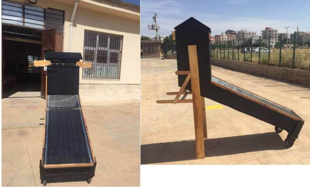
Şekil 3.12. Güneş enerjili kurutma sistemi.
