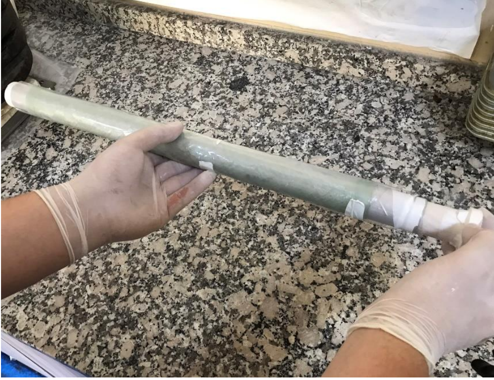
Şekil 4.11. Alçı kalıbın alüminyum tüp içine yerleştirilmesi.
