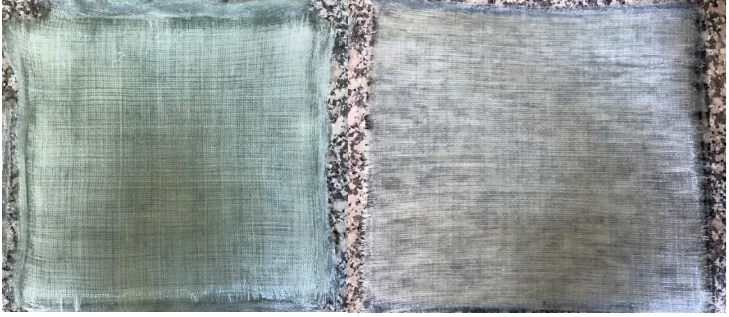
Şekil 4.5. El yatırma yöntemi ile hazırlanmış levhalar.
