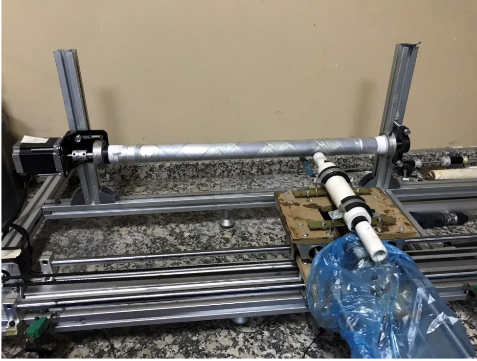
Şekil 4.9. Fiber sarım makinesinde numune üretimi.
