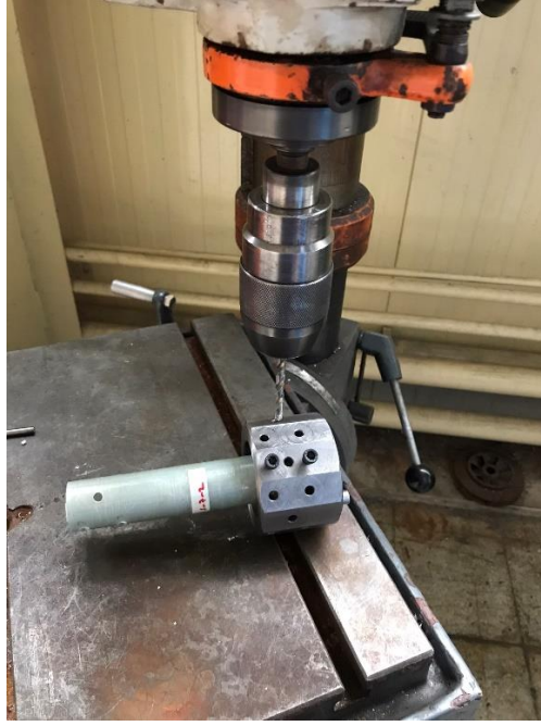
Şekil 4.15. Numunelere pim deliklerinin açılması.
