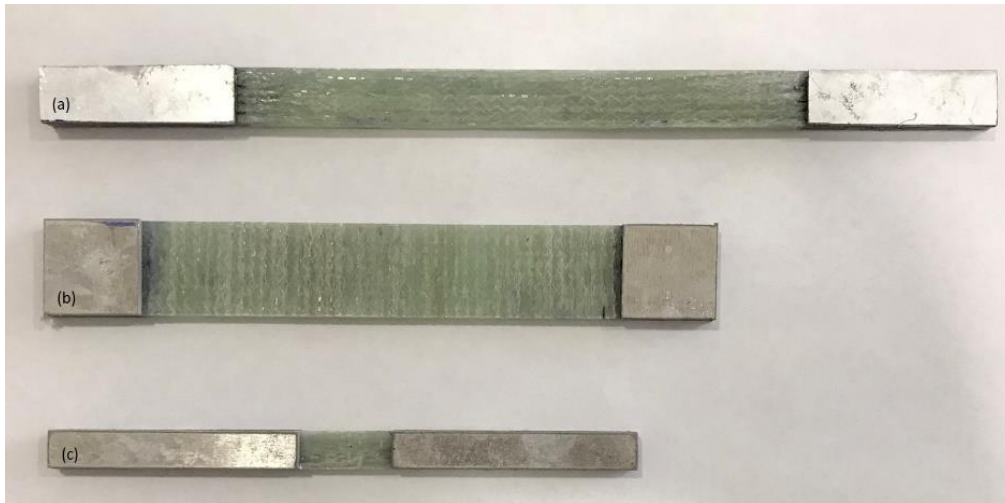
Şekil 4.6. (a) fiber yönünde çekme numunesi, (b) fibere dik yönde çekme numunesi, (c) fiber yönünde basma numunesi.
