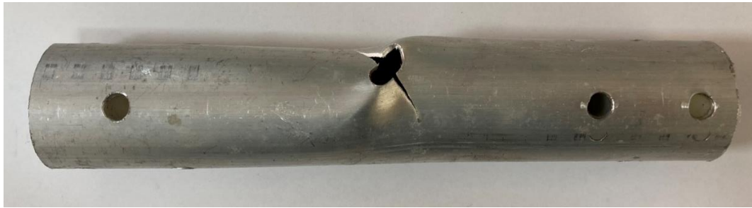
Şekil 5.12. M8 delik delinmiş alüminyum tüpün deney sonrası hali.
