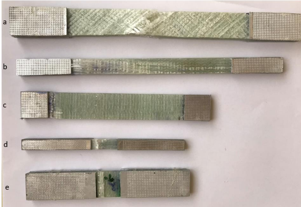
Şekil 5.8. Fiber takviyeli kompozitlerin çekme, basma ve kayma deneyleri sonrası hasar görüntüleri a)kayma ( 45^0 ) deneyi, b) fiber yönünde çekme deneyi, c) fibere dik çekme deneyi, d) fiber yönünde basma deneyi, e) fibere dik yönde basma deneyi.
