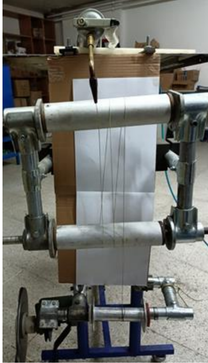
Şekil 13.1. Sentezlenmiş polimerin iplik haline getirilmesi düzeneği-a
