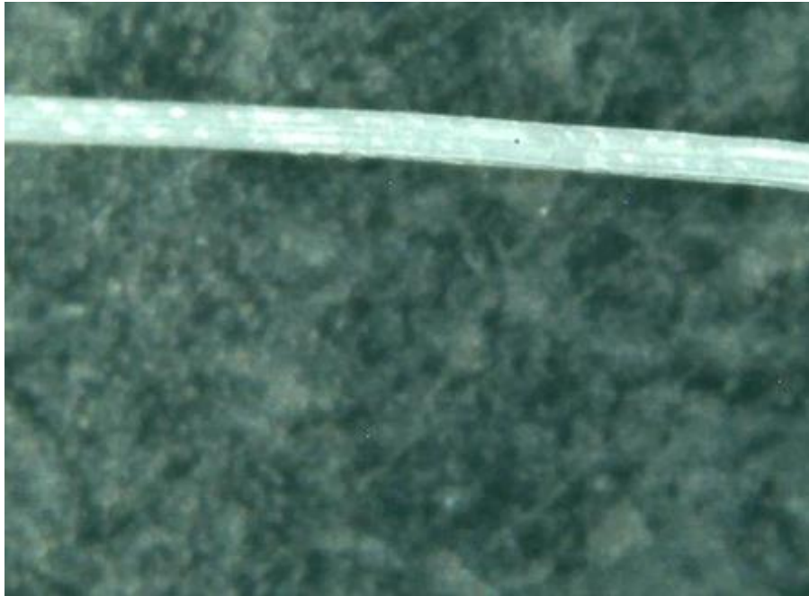
Şekil 12.6. 40 Denye yumuşak elastan büyüteç görüntüsü. Ölçek: 1/150
