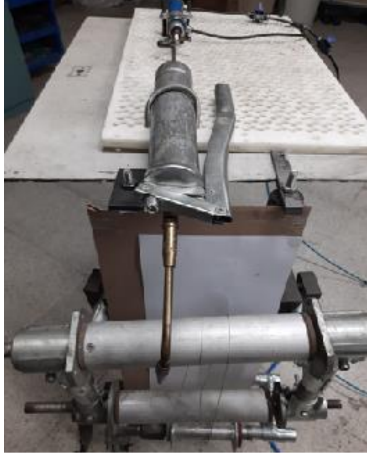
Şekil 13.2. Sentezlenmiş polimerin iplik haline getirilmesi düzeneği-b
