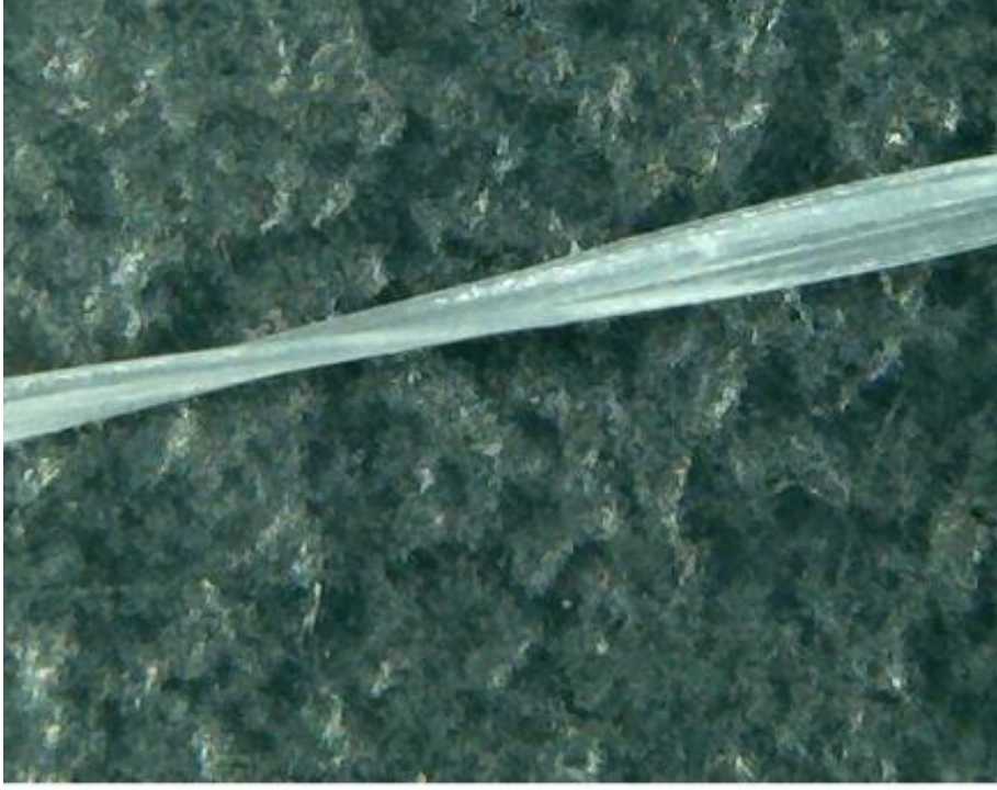
Şekil 12.7. 40 Denye sert elastañ büyüteç görüntüsü. Ölçek: 1/150
