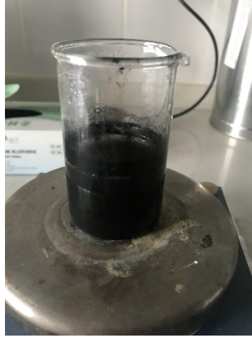
Şekil 4.4. Manyetik karıştırıcıdaki grafit, \text{NaNO}_3 ve \text{H}_2\text{SO}_4 karışımı.
