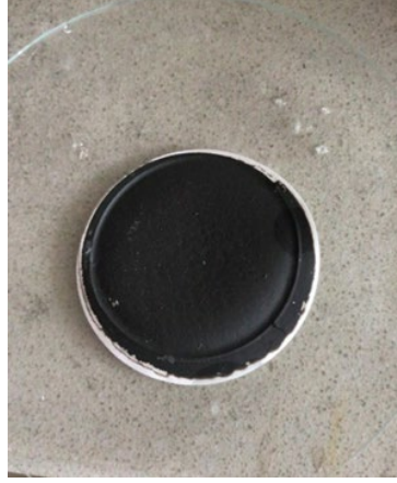
Şekil 4.5. Kâğıt şeklindeki esnek, serbest h-BN/rGO/S kompozit film.
