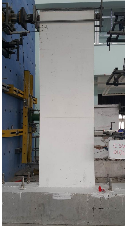
Şekil 6.11. CSW-3 numunesinin deney başlangıç aşamasındaki görünüşü
