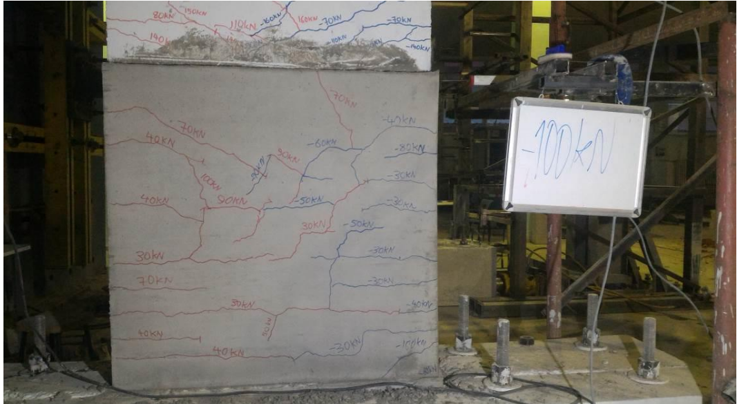
Şekil 6.20. 100 kN çekme yükü altında çatlak dağılımı
