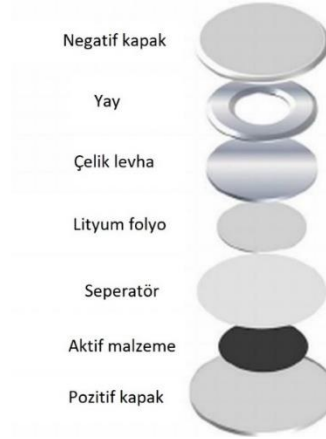
Şekil 5.9. CR2032 düğme tipi hücrenin birleştirilmesinin şematik gösterimi.
