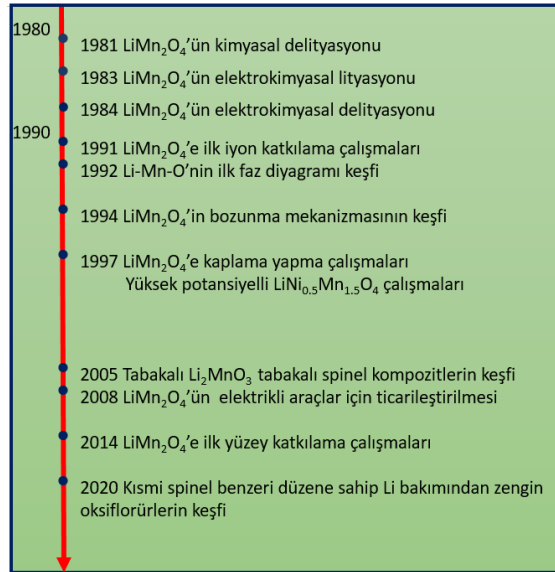
Şekil 4.1. Spinel katotların tarihsel gelişimi
