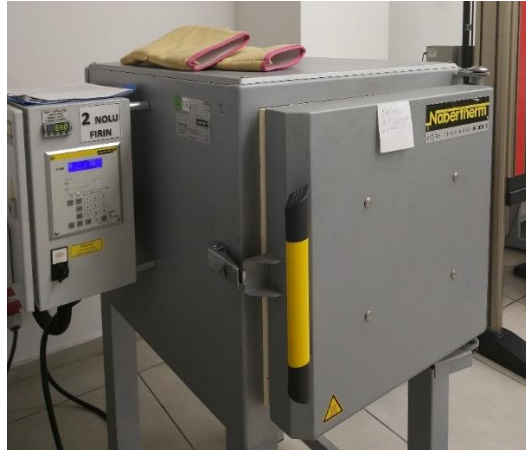
Şekil 3.2. Laboratuvar tipi ısıl işlem fırını.
