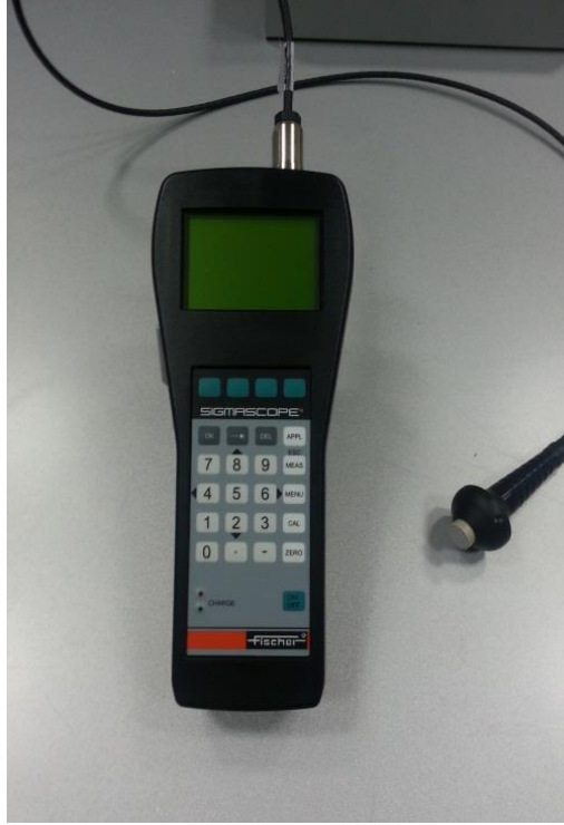
Şekil 3.5. Elektrik iletkenlik ölçümü.
