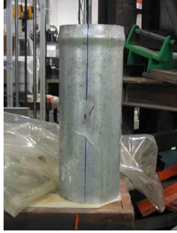
Şekil 2.1. Lokal burkulmaya uğramış kolon [43].
