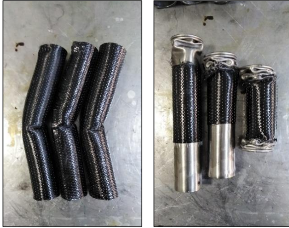
Şekil 5.17. Tam olarak sarılan kolon ile kısmi olarak sarılan kolonların deformasyon şekilleri.
