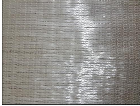
Şekil 3.9. Tek yönlü 330 gr ağırlıklı cam elyaf kumaş.
