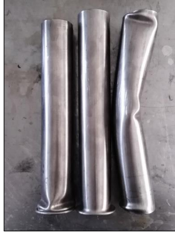
Şekil 5.14. Hasarsız numunelerin basma sonrası burkulma davranışı.
