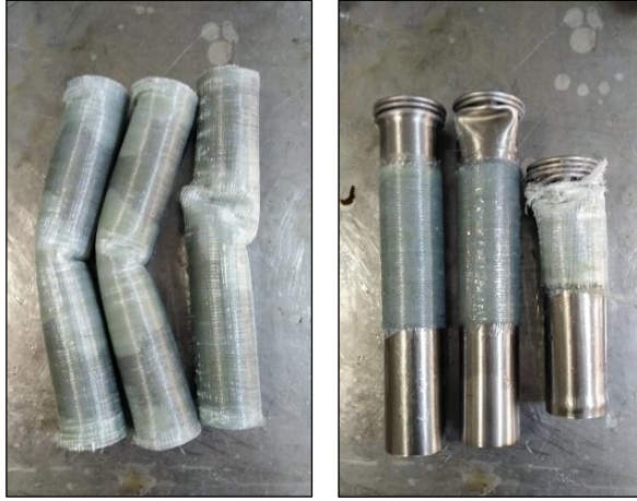
Şekil 5.18. Tam olarak sarılan kolon ile kısmi olarak sarılan kolonların deformasyon şekilleri.
