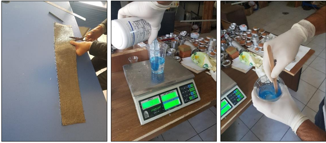
Şekil 3.14. Elyafın kesilmesi, epoksi harcın belirli oranlarda karıştırılması.
