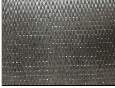
Şekil 3.10. Tek yönlü 300 gr ağırlıklı karbon elyaf kumaş.
