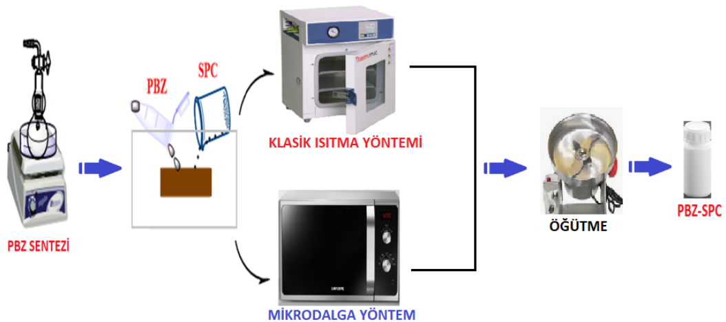
Şekil 4.9. PBZ ve PBZ-SPC sentezi çalışma görseli.
