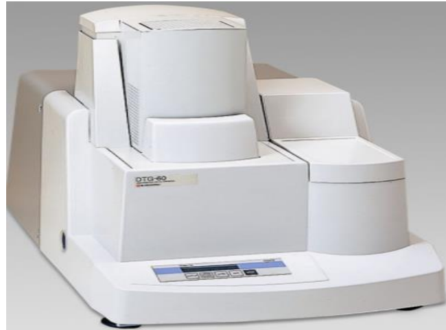
Şekil 4.6. PBZ tabanlı polimerlerin termal analizinde kullanılan DTG ölçüm cihazı.
