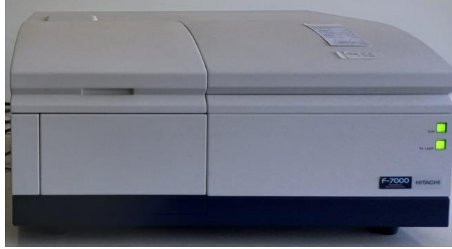
Şekil 4.5. PBZ tabanlı polimerlerin analizinde kullanılan floresans ölçüm cihazı.
