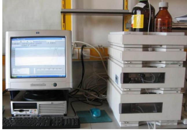
Şekil 4.7. PBZ tabanlı polimerlerin analizinde kullanılan GPC ölçüm cihazı.
