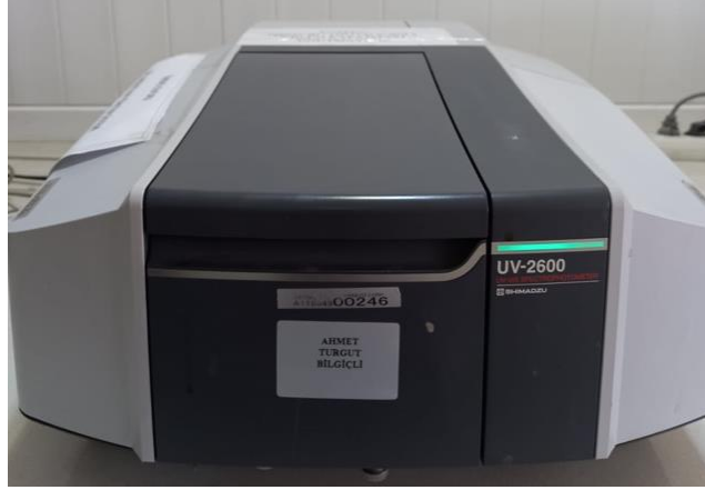
Şekil 4.4. PBZ tabanlı polimerlerin analizinde kullanılan UV-Vis spektroskopi cihazı.
