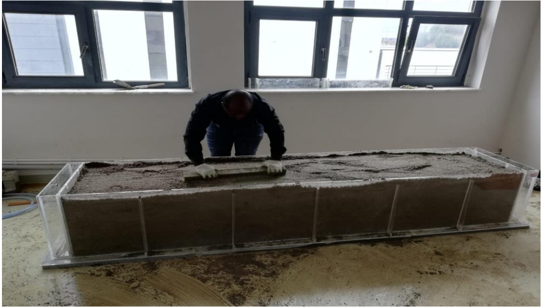
Şekil 3.2. Deney A için tanktaki kum seviyesinin ayarlanması sırasında çekilen resim.
