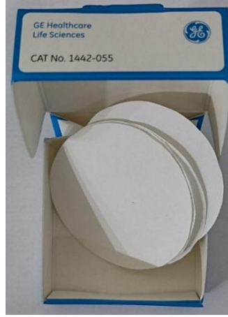
Şekil 4.9. Filtre kağıdı deney yönteminde kullanılan Whatman No.42 filtre kağıdı.
