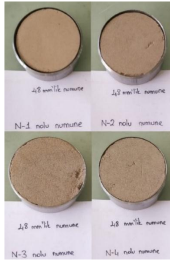
Şekil 4.12. Filtre kağıdı deney sonunda numunelere ait son haller.
