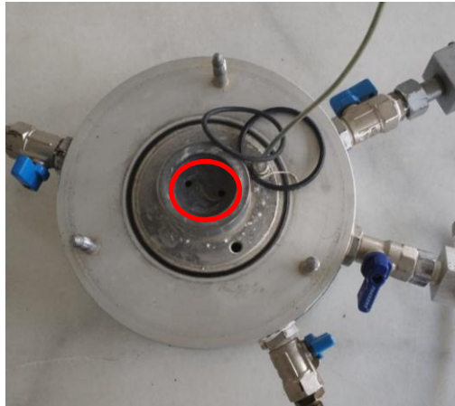
Şekil 4.17. Alt pedestal içerisine açılan helezon biçimli detay.
