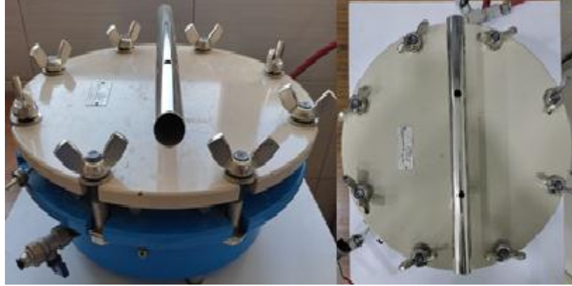
Şekil 4.13. 15 bar basınca dayanıklı basınç plakası hücresi.
