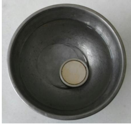
Şekil 4.24. 5 barlık seramik poroz taş ve filtre kağıdının doyurma aşaması.
