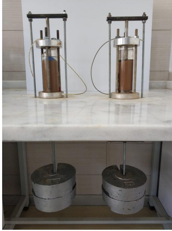
Şekil 4.6. 100 kPa altında tek boyutlu konsolidasyon işlemi.
