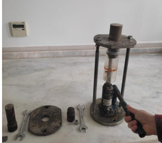
Şekil 4.7. Dondurucudan çıkarılan numunelerin şeffaf hücreden çıkarılma işlemi.
