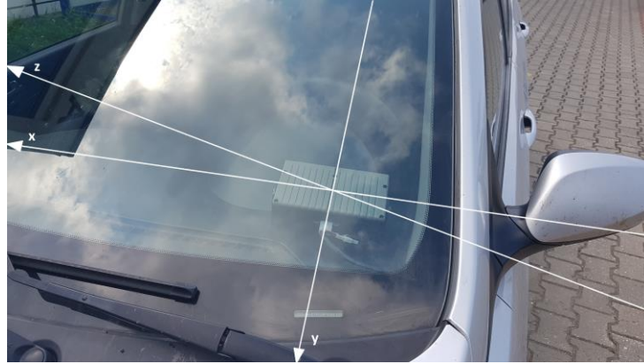
Şekil 5.1. Araca monte edilen prototip takografı cihazı
