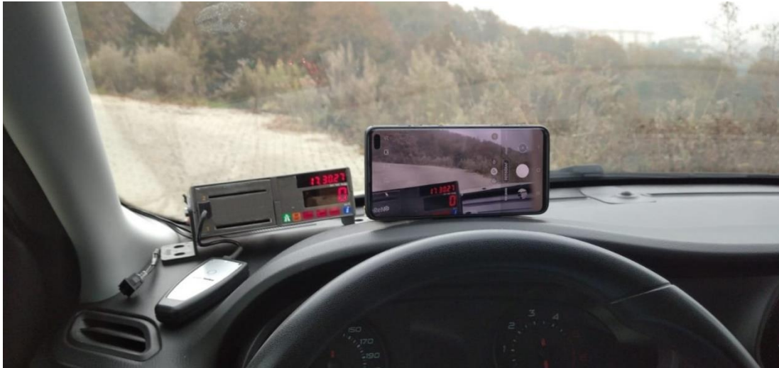
Şekil 5.9. Yolculukta takograf ekranı ve yolun kaydedildiği sistem
