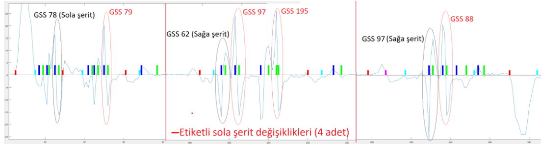
Şekil 4.33. Yolculuk-21 şerit değişikliklerinin G_z grafiği ve GSS büyüklükleri
