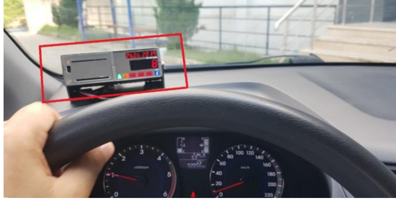
Şekil 4.3. Araca monte edilen takograf cihazı
