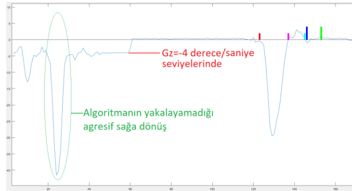
Şekil 4.31. Yolculuk-20 algoritmanın kaçırdığı agresif sağa dönüş manevrası
