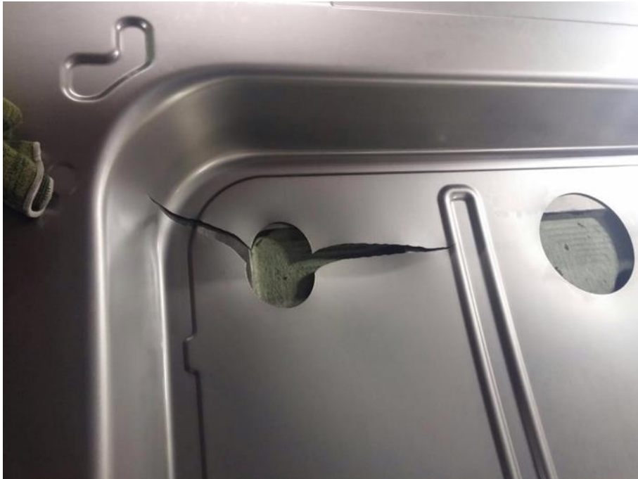
Şekil 5.1. Açınım boşaltmasında oluşan yırtık probleminin görseli
