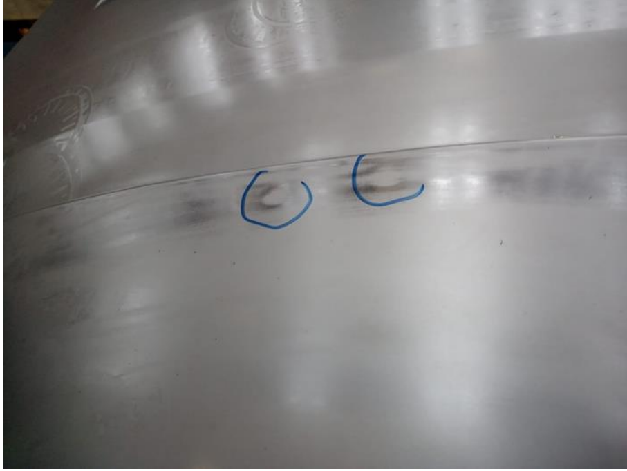
Şekil 3.11. Şekillendirilmiş bir parça üzerinde kalıp izi görünümü
