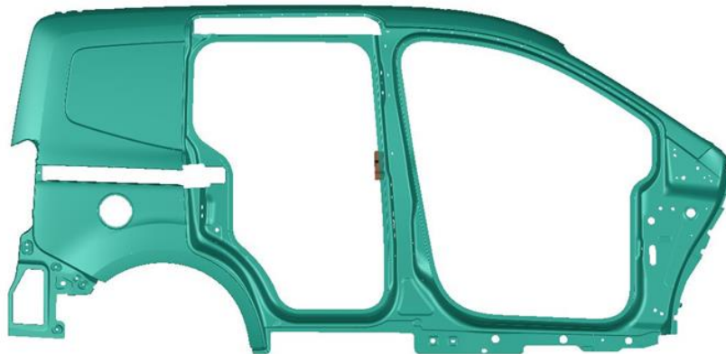
Şekil 2.7. Tüm operasyonları tamamlanmış, yarı mamul bir sac malzemenin şematik gösterimi.
