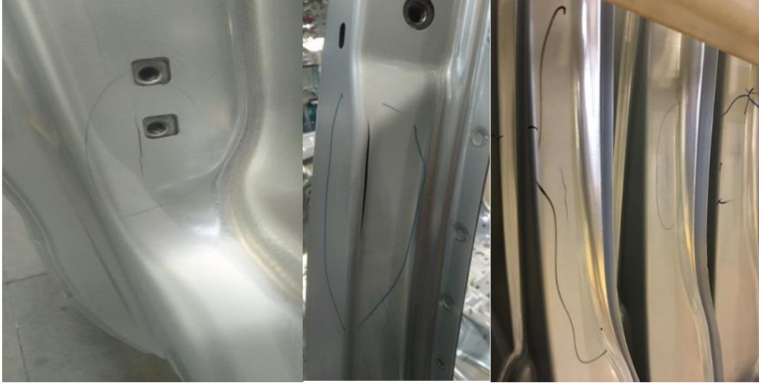
Şekil 3.1. Şekillendirilmiş sac üzerinde yırtık probleminin gösterimi
