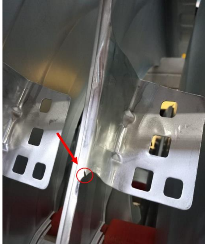
Şekil 3.9. Şekillendirilmiş bir parça üzerinde oluşmuş çatlak görünümü
