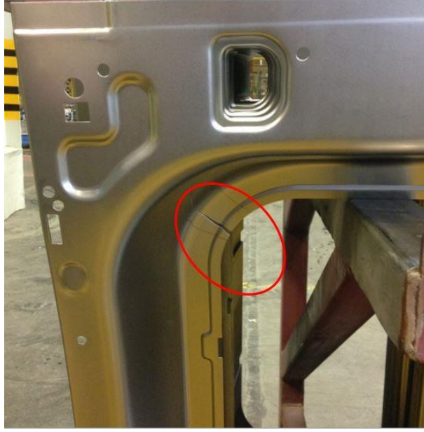
Şekil 5.2. Açınım boşaltmasında oluşan yırtığın final parça içine ulaşmış hali
