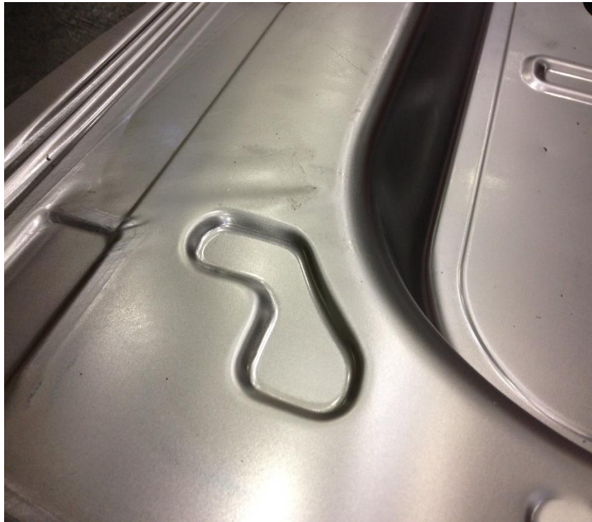
Şekil 5.5. Yırtık probleminin giderilmesi için yapılan müdahale sonucu pot probleminin görünümü
