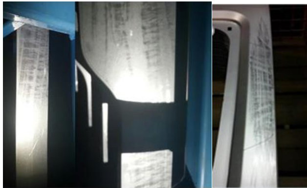
Şekil 2.16. Şekillendirilmiş bir otomotiv parçasında lüders bantları oluşumu
