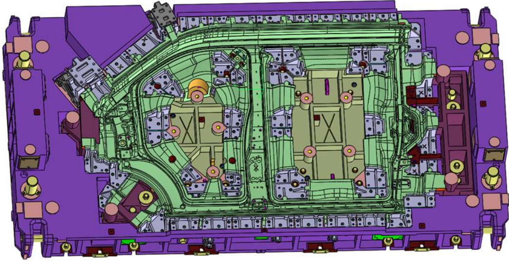
Şekil 2.9. Bir kesme üst kalıbının şematik gösterimi
