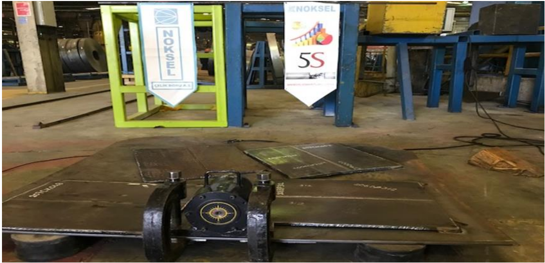
Şekil 5.6. Titreşimle gerilim giderme hazırlık süreci
