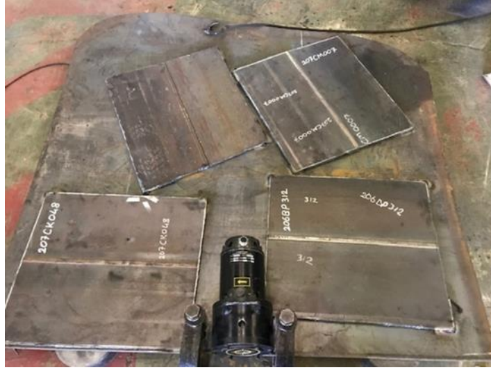
Şekil 6.1. Titreşimle gerilim giderme işlemi çalışma düzeni
