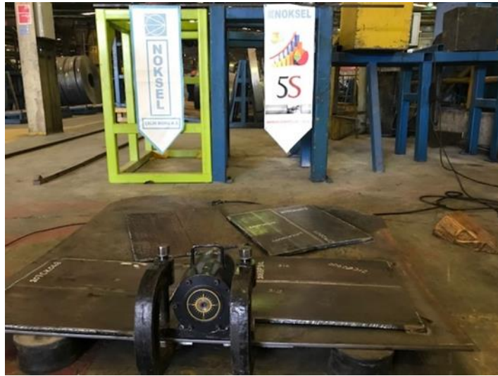
Şekil 6.2. Mekanik titreşim oluşturacak üretcin monte edilmesi
