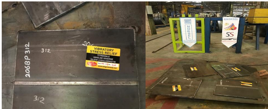
Şekil 6.4. Titreşimle gerilim giderme işlemi sonrası tanımlama yapılması
