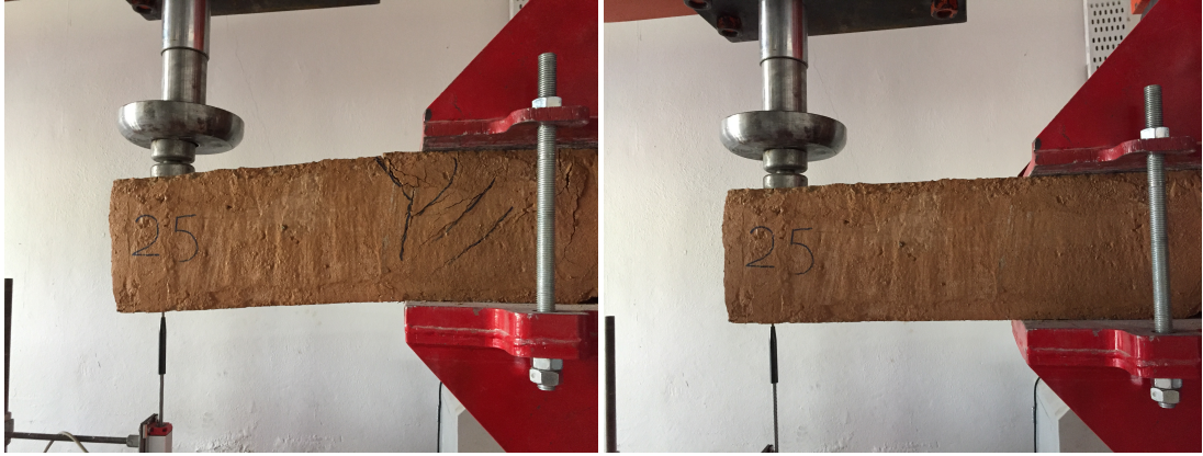
Şekil 5.4. 25 nolu seriye ait kırılma öncesi ve sonrası
