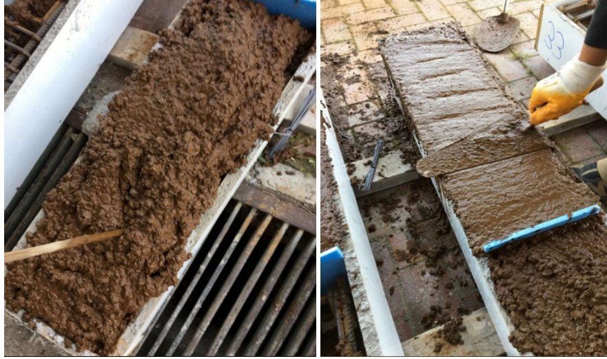
Şekil 4.10. Numune şişlenip masterlanması
