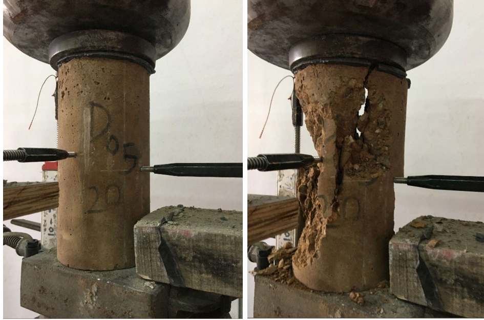
Şekil 4.17. Silindir numune basınç deneyi
