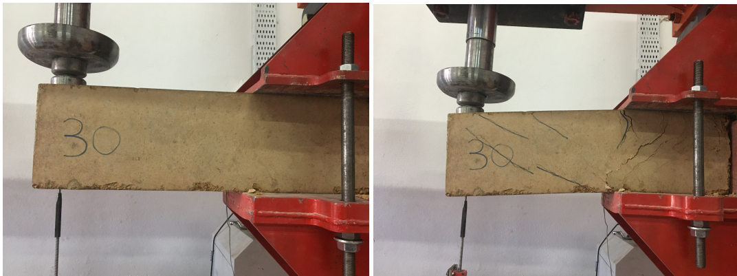
Şekil 5.3. 30 nolu seriye ait kiriş kırılma öncesi ve sonrası
