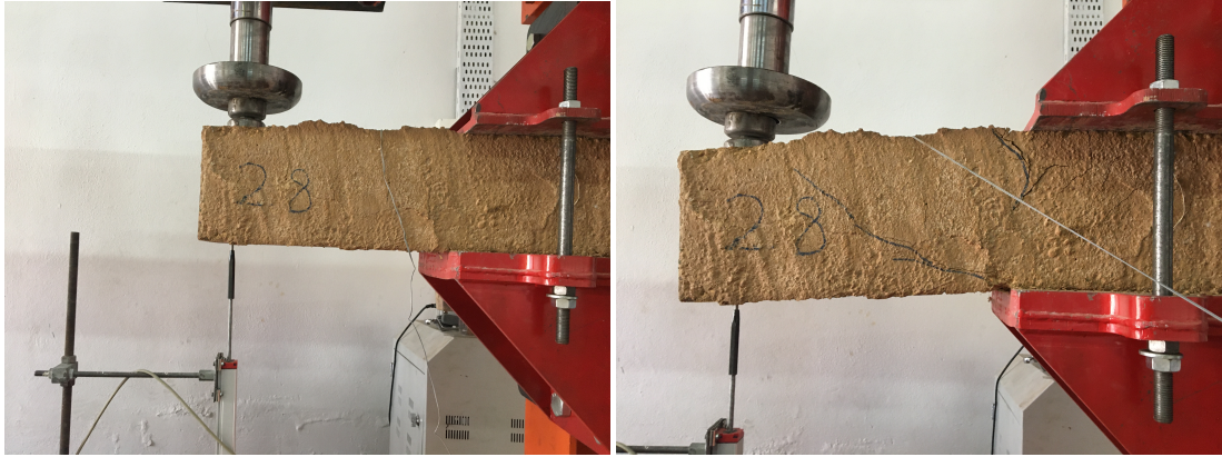
Şekil 5.5. 28 nolu kirişe ait kırılma öncesi ve sonrası
