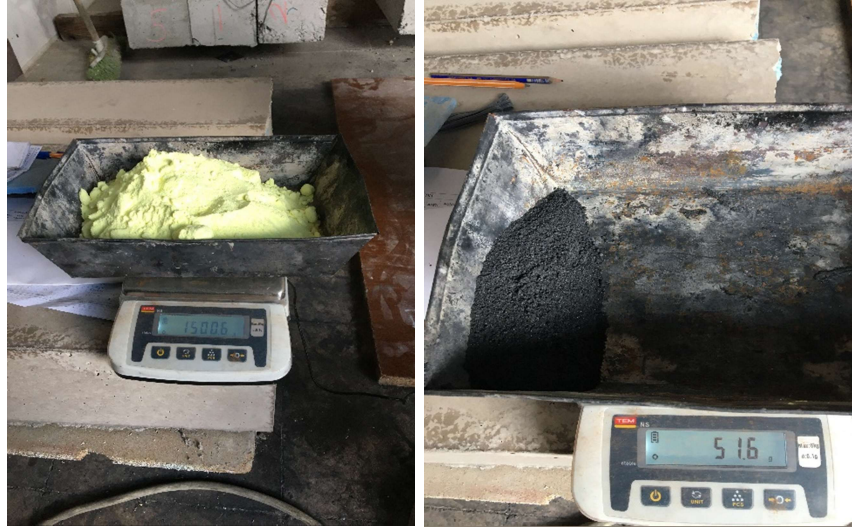
Şekil 4.14. Kükürt - grafit hassas terazide tartılması
