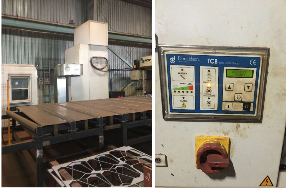
Şekil 1.1. Demir tozunun toplandığı hava filtre makinesi
