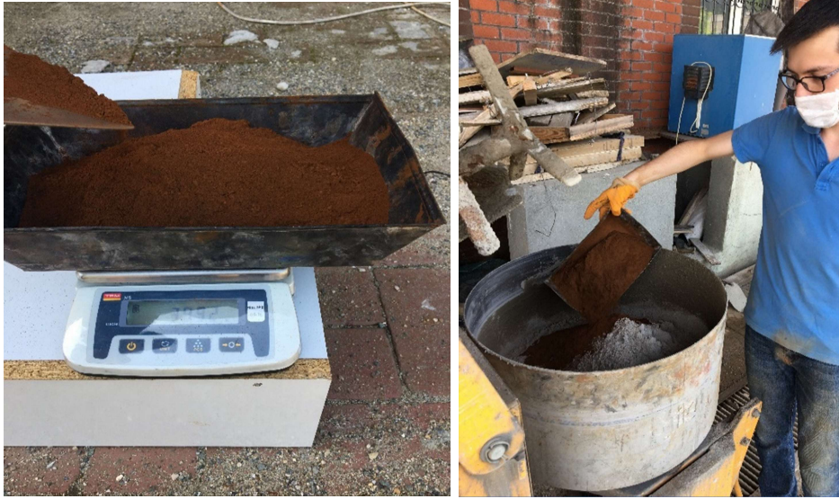
Şekil 4.8. Demir tozu tartılıp eklenmesi
