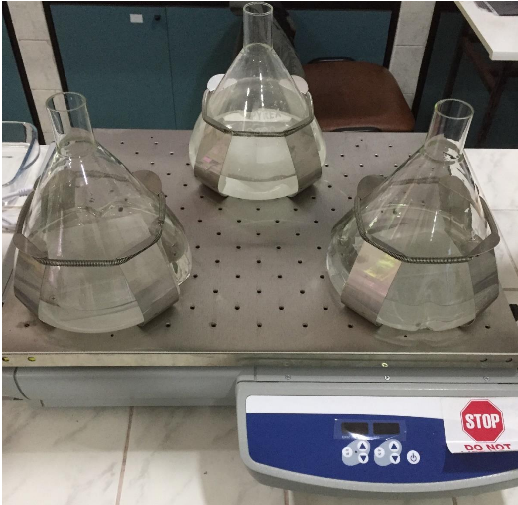
Şekil 3.1. Orbital karıştırcı ve 2,8 L hacimli Fernbach erlenleri
