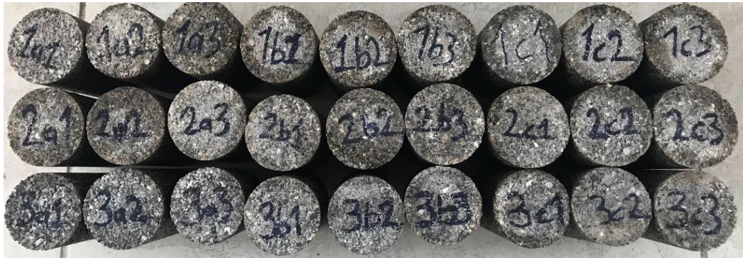
Şekil 3.17. Basma testi numuneleri.
