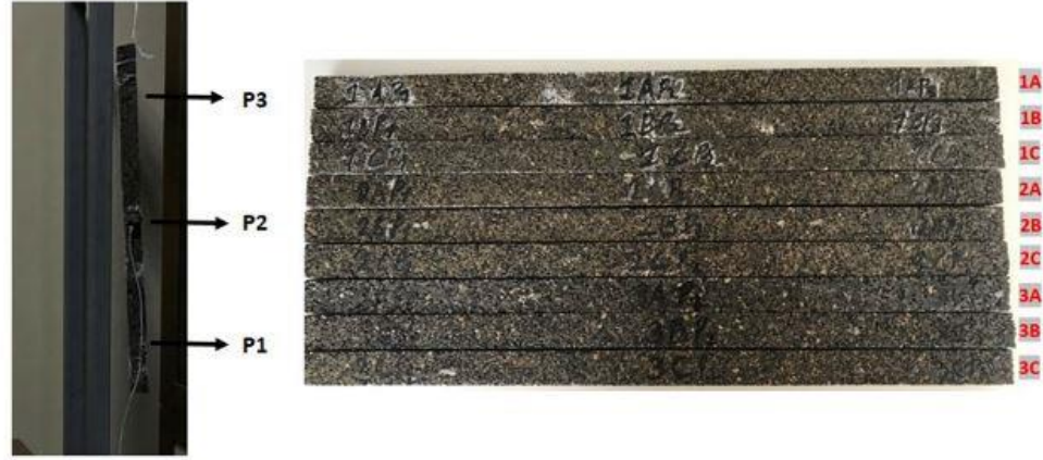
Şekil 3.10. Titreşim testlerinde kullanılan numuneler ve ivmeölçer yapıştırılma noktaları.
