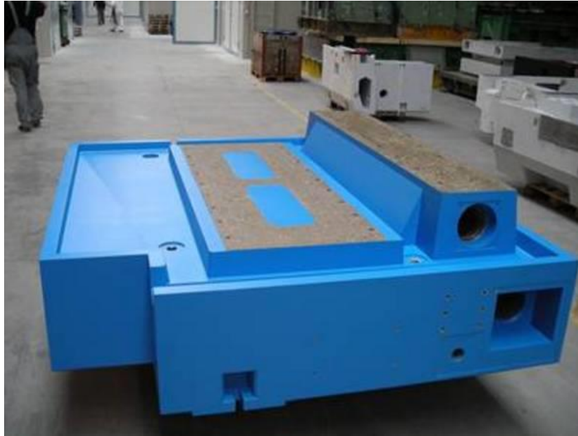
Şekil 2.3. Mineral döküm doldurulmuş tezgâh şasesi.
