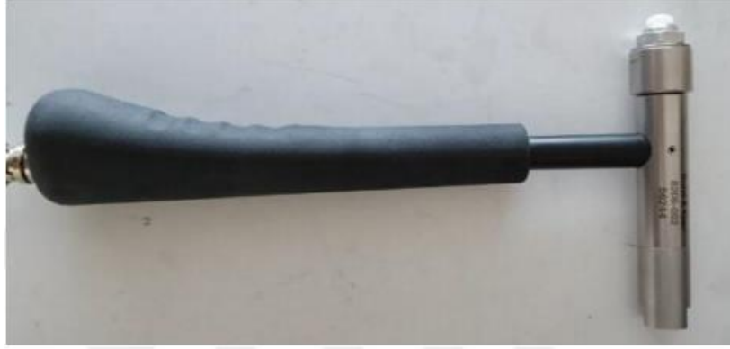
Şekil 3.12. Brüel&Kjaer Type 8206-002 model darbe çekici.
