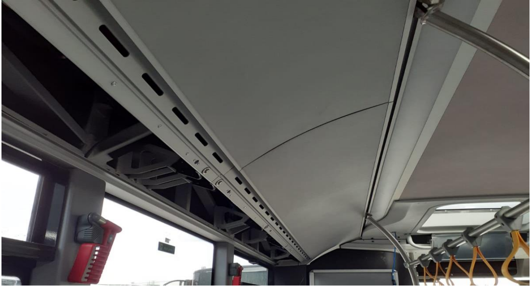
Şekil 4.13. Hava kanalının otobüs tavana montajı
