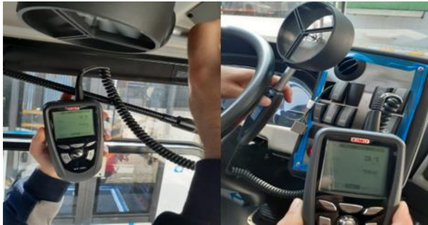
Şekil 5.3. 17 °C Sıcaklıkta şoför hava çıkış hızı ve sıcaklık
