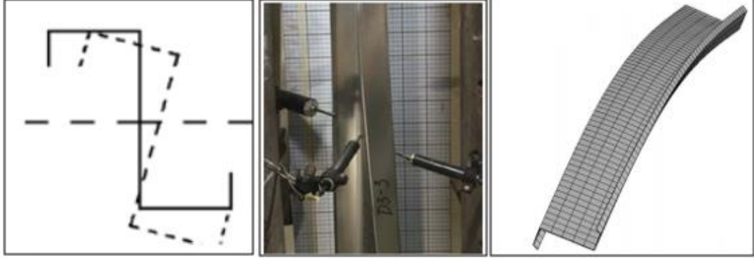
Şekil 5.1.Nokta Simetrisi Bulunan Z Profillerinin Genel Burkulma Davranışı
