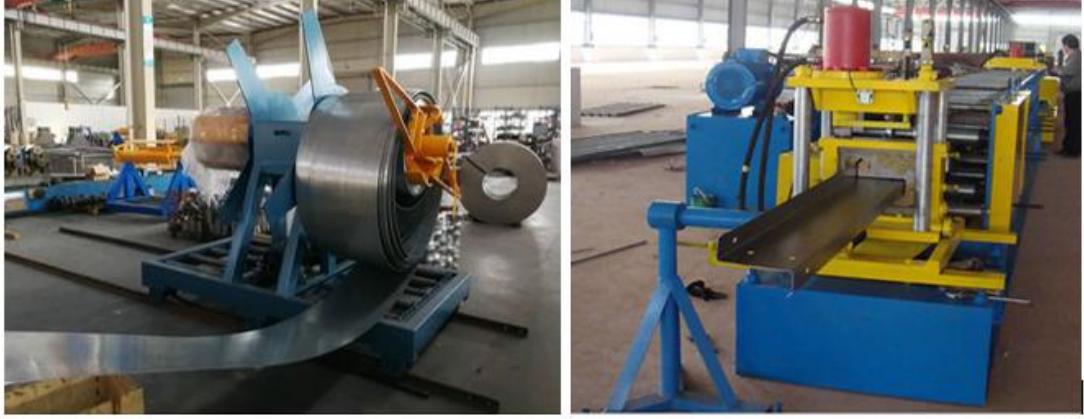
Şekil 3.8. Soğukta şekil verilmiş Z geometrili çelik levhanın şekil verilme öncesi ve sonrası [44]
