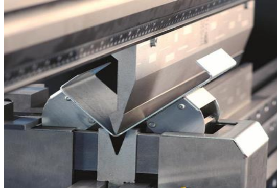
Şekil 3.7.Çelik levhaların presle şekil verme yöntemiyle şekillendirilmesi [43]
