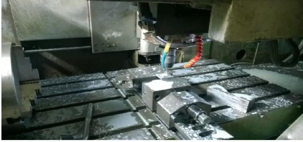
Şekil 4.11. Dairesel ve kare kesitli pin dizisi içeren PMC yapının prototip üretim anını gösteren görsel.
