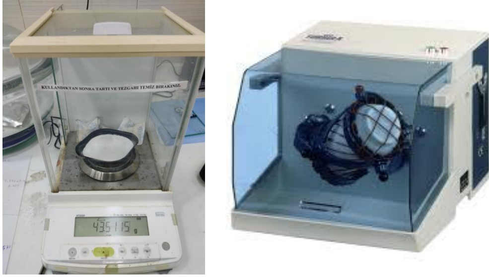
Şekil 3.3. Ağırlıkça karışım oranlarının hazırlanmasında kullanılan hassas tartı ve hazırlanan karışımların karıştırılması için kullanılan makina (Turbula T2F).
