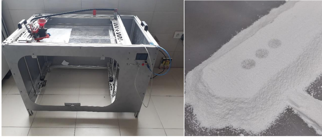
Şekil 3.6. Numune üretiminde kullanılan 3D Printer ve Binder Jetting yöntemiyle üretimi tamamlanmış test numuneleri.
