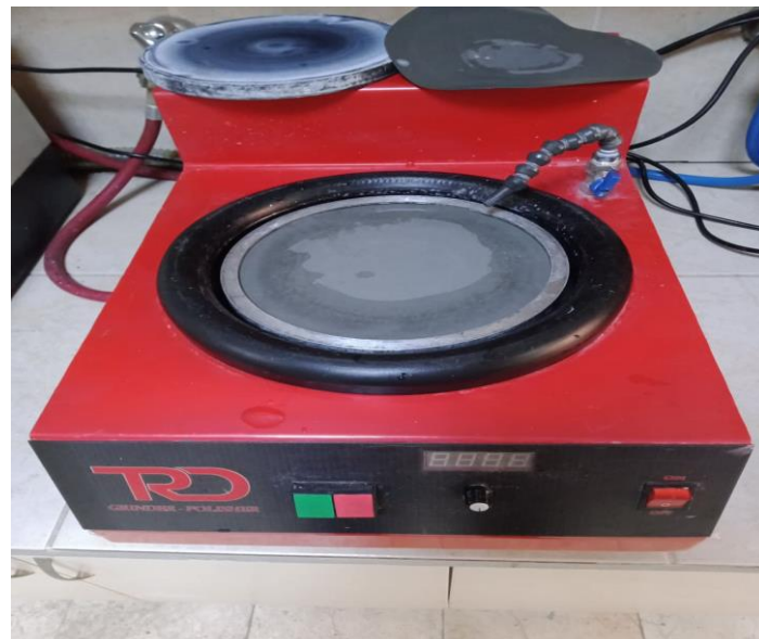
ekil 3.3. Deneyde kullanılan zımparalama ve parlatma makinesi
