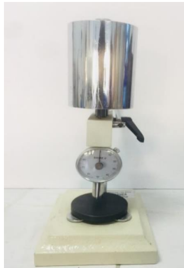
Şekil 2.6. Sertlik deneylerinin yapıldığı Shore D sertlik ölçüm cihazı
