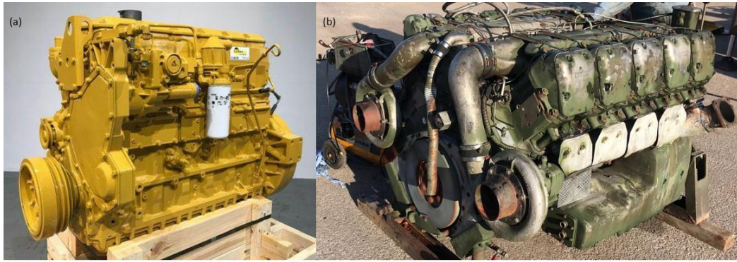
Şekil 3.3. A) I-tipi motor, B) V-tipi motor
