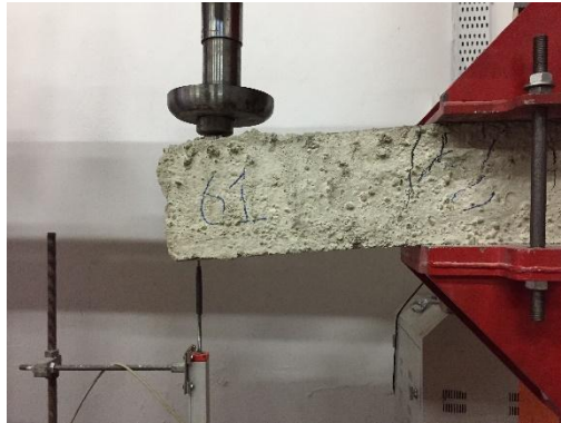
Şekil 4.7. %40 demir talaşı katkılı olan deney numunesinin deney sonrası görüntüsü
