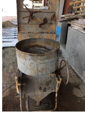
Şekil 3.9. Beton makinesinin görüntüsü
