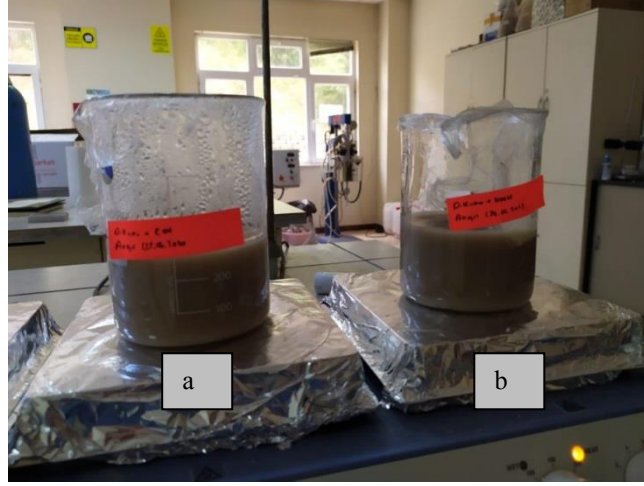
Şekil 4.11. Döküm kumuna a. 1 mol KOH ve b. 1 mol NaOH bazları ilave edilerek hazırlanan çözeltiler
