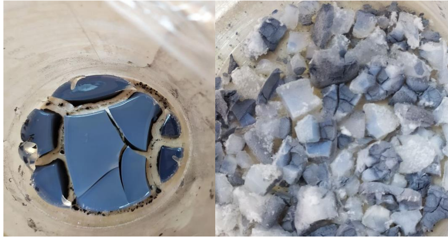
Şekil 4.10. ADK'na a. n-heptan ilavesi yapıldıktan sonraki hali, b. kurutma aşaması sonrası elde edilen silika esaslı aerojel tozları
