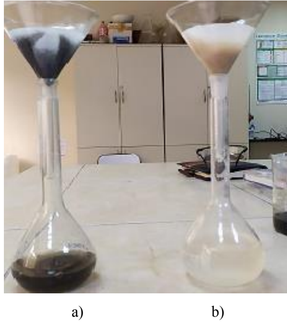
Şekil 4.4. a. Atık döküm kumu, b. Döküm kumu içeren karışımın filtre kağıdı ile süzülme işlemi.
