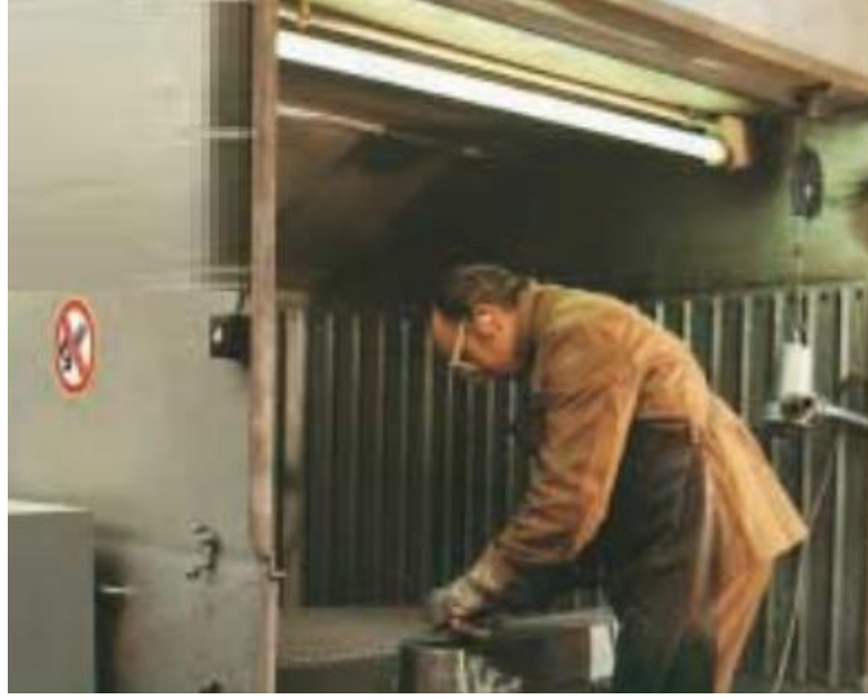
Şekil 2.27. Parlama yapan iş süreçlerinde ortam güvenliği (GUV-I 560)
