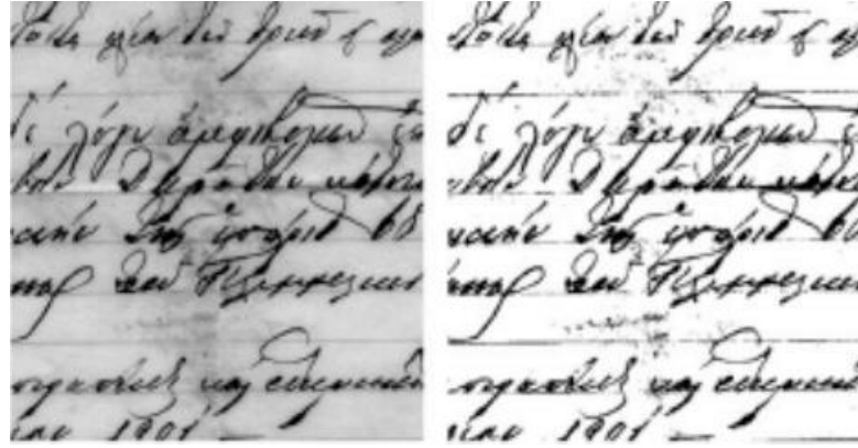
Şekil 2.2. Eşikleme ile arka plan renginin değiştirilmesi [7]
