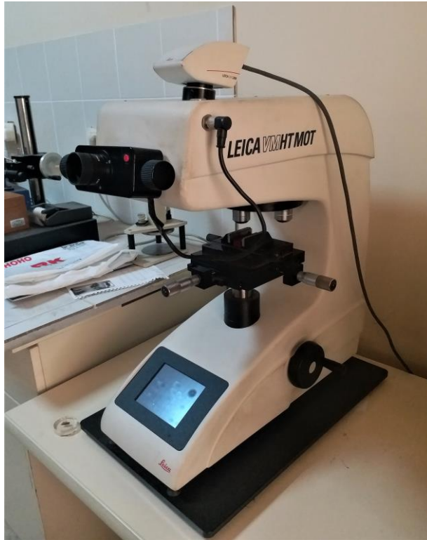
Şekil 6.13. Kırılma tokluğu ve sertlik ölçümü yapılan mikrosertlik cihazı.
