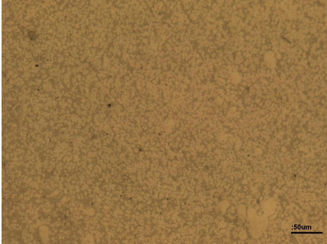
Şekil 6.4. Enjeksiyon döküm yöntemiyle üretilmiş ısıtılmış işlemlenmiş C1 alaşımı
