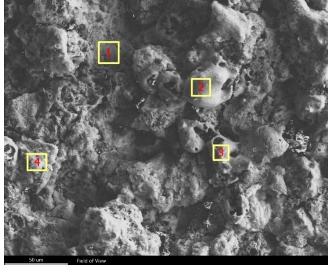
Şekil 4. 17. Silikatlı elektrolit içerisinde kaplanan saf Al üzerinde oluşturulan MAO kaplamanın yüzey SEM görüntüsü.
