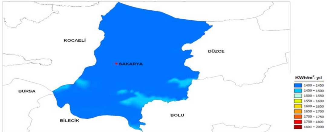
Şekil 4.7. Sakarya İli Toplam Güneş Radyasyonu Dağılımı [92]
