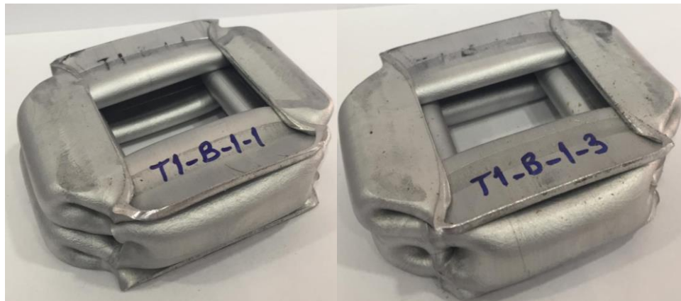
Şekil 3.15. 6063-T6-E-0-0 tüplerin aksel ezme deneyi sonrası deformasyon görünümleri
