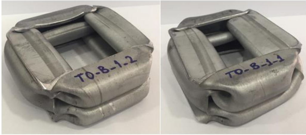
Şekil 3.5. 6063-T0-E-0-0 tüpün aksel eyme deneyi sonrası deformasyon görünümü
