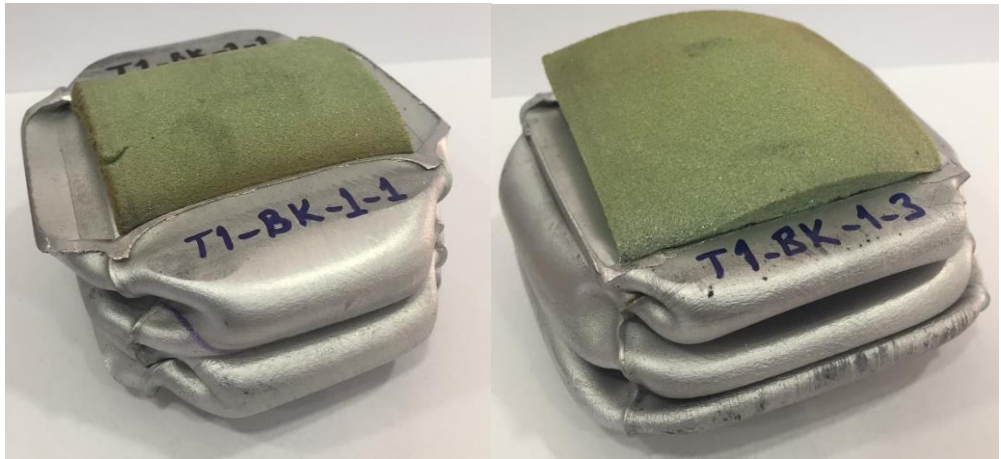
Şekil 3.19. 6063-T6-E-K-0 tüplerin aksenal ezme deneyi sonrası deformasyon görünümü
