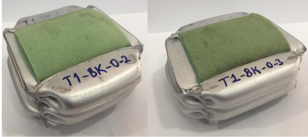
Şekil 3.17. 6063-T6-0-K-0-0 tüplerin aksel ezme deneyi sonrası deformasyon görünümü
