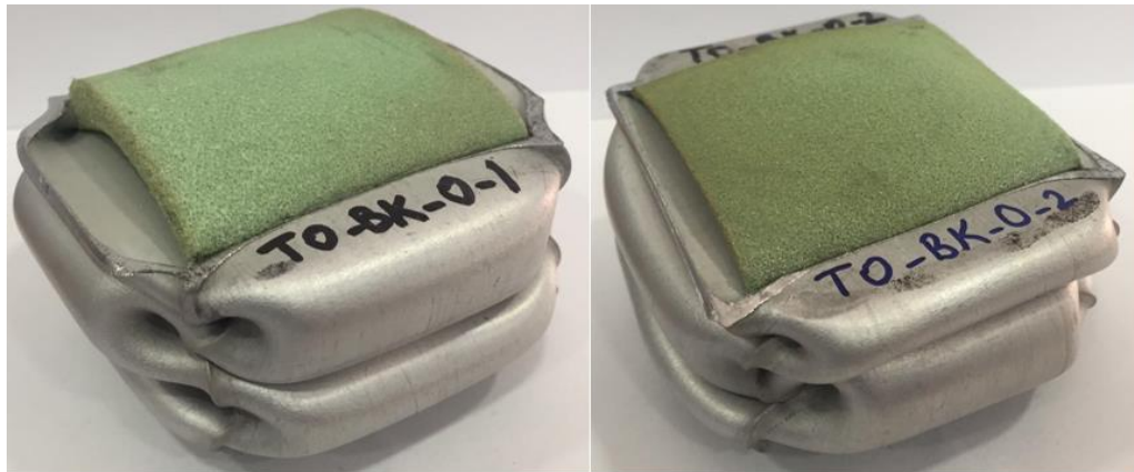
Şekil 3.7. 6063-T0-0-K-0 tüplerin aksel ezme deneyi sonrası deformasyon görünümü
