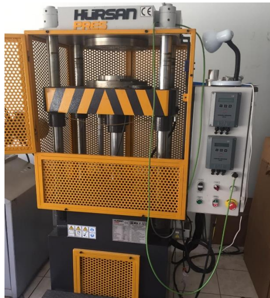
Şekil 2.13. Eksenel ezme deneyinde kullanılan hidrolik pres
