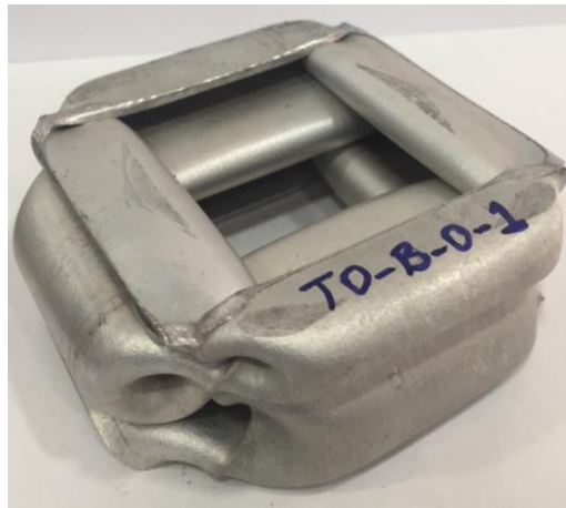
Şekil 3.3. 6063-T0-0-0-0 tüpün aksel ezme deneyi sonrası deformasyon görünümü
