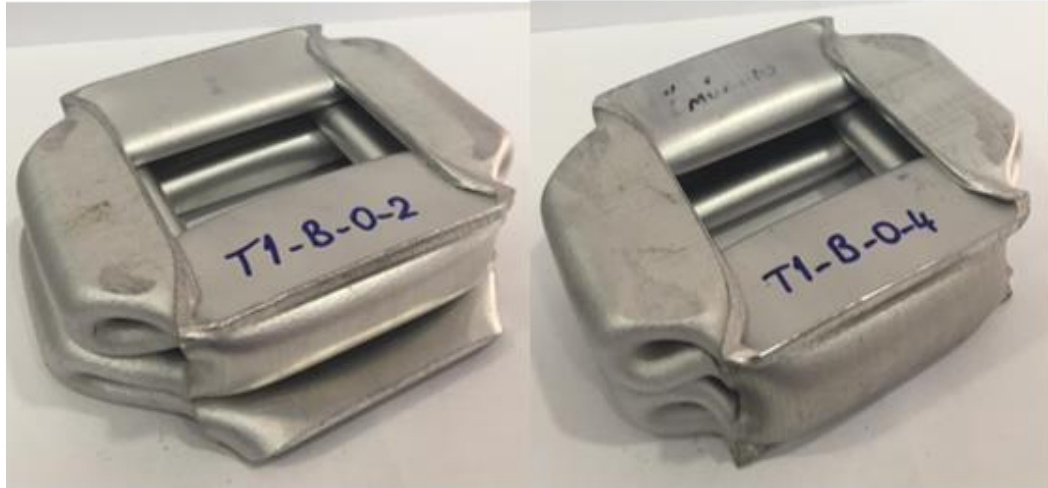
Şekil 3.13. 6063-T6-0-0-0 tüplerin aksel ezme deneyi sonrası deformasyon görünümü
