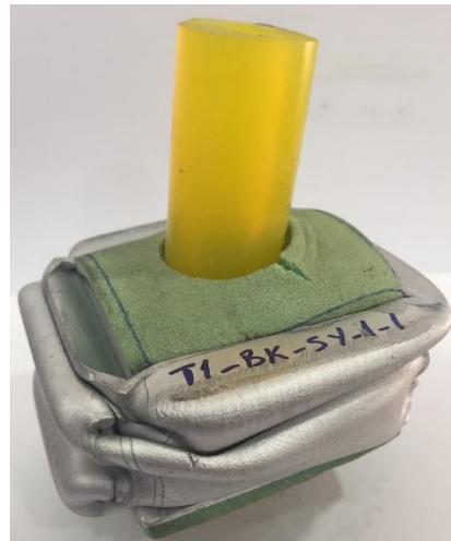
Şekil 3.25. 6063-T6-E-K-1 tüplerin eksenel ezme deneyi sonrası deformasyon görünümü
