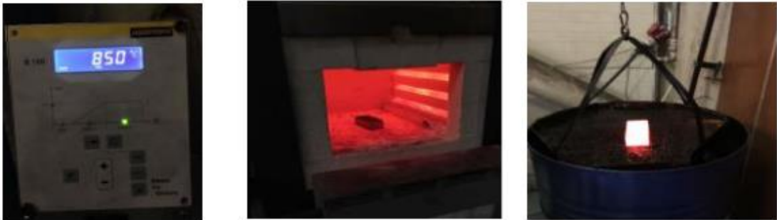
Şekil 2.2. Soğuk iş takım çeliği ısıl işlem süreci
