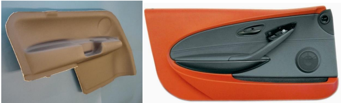
Şekil 3.12. Volkswagen iç kapı paneli (solda) [12] , Intier Redditch tarafından üretilen BMW mini kapı paneli- 800 Ton- 1+1 kavite kalıp (sağda) [17]
