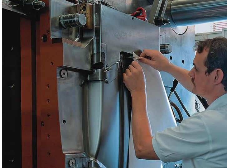
Şekil 3.19. Kumaş yapının çelik üzerinde kliplere yerleştirilmesi [21]
