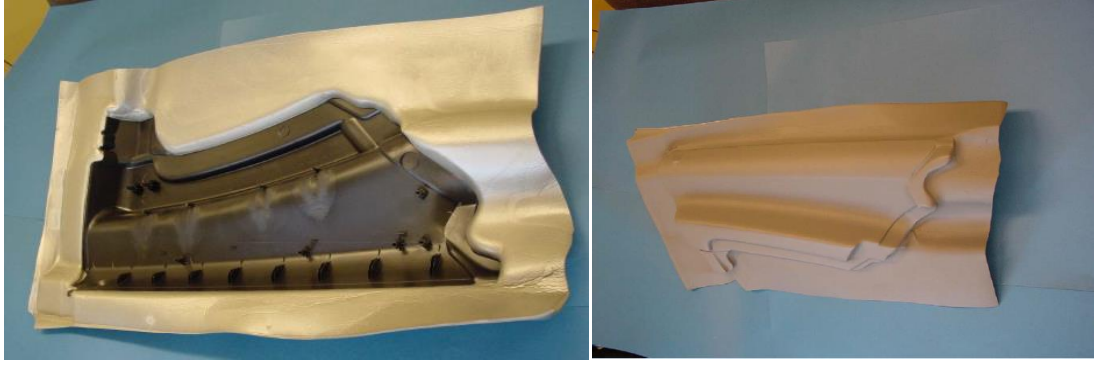
Şekil 3.1. TPO-film Daimler Chrysler Vito ile iç cephe kaplama parçası [12]
