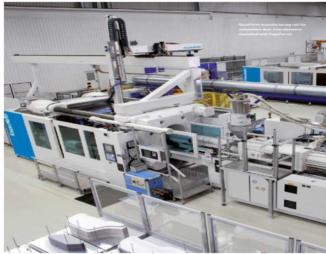
Şekil 3.20. Otomotiv kapı trim elemanları için DecoForm üretim sahası [11]
